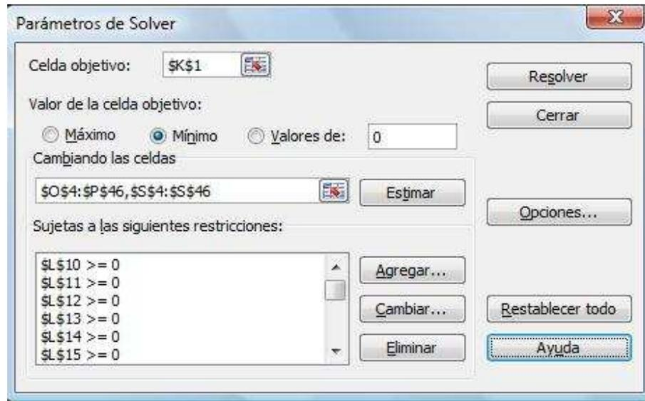
Fig. A2.2. Definición del problema de programación lineal con Solver.
