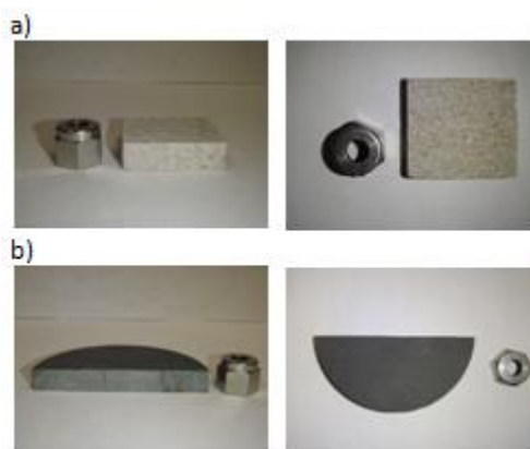
Figura 5.3. Placas de roca: a) Caliza Bedford; b) Dolomía.
