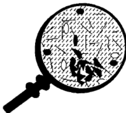
Figure 1.31. Flocculación y precipitación de componentes pesados por la adición de un solvente no polar miscible (línea en forma de guión = un hidrocarburo parafínico) (reimpreso de Journal of Petroleum Science and Engineering , Vol. 17, Mansoori, G. A., "Modeling of Asphaltene and Other Heavy Organic Depositions, pp. 101-111, ©1997, con el permiso de Elsevier Science; después de Mansoori ©1994 SPE; reimpreso con el permiso de la Society of Petroleum Engineers).
