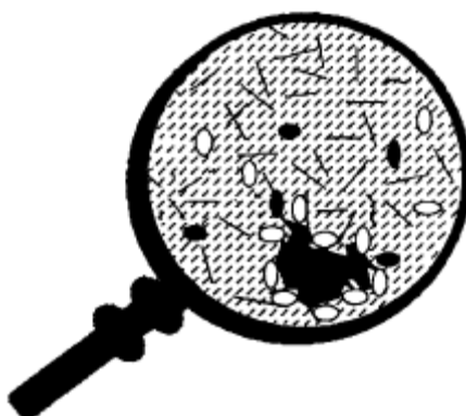
Figure 1.32. Fenómeno estérico coloidal activado por la adición de hidrocarburos parafínicos (reimpreso de Journal of Petroleum Science and Engineering , Vol. 17, Mansoori, G. A., "Modeling of Asphaltene and Other Heavy Organic Depositions, pp. 101-111, ©1997, con el permiso de Elsevier Science; después de Mansoori ©1994 SPE; reimpreso con el permiso de la Society of Petroleum Engineers).
