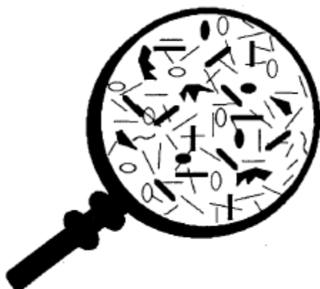
Figura 1.29. Orgánicos pesados en el petróleo crudo (líneas rectas/curvas = moléculas de parafinas, elipses sólidas = moléculas aromáticas, elipses abiertas = moléculas de resinas, y formas de bloques sólidos = moléculas de asfalto) (reimpreso de Journal of Petroleum Science and Engineering , Vol. 17, Mansoori, G. A., "Modeling of Asphaltene and Other Heavy Organic Depositions", pp. 101-111, ©1997, con permiso de Elsevier Science; después SPE; reimpreso con permiso de la Society of Petroleum Engineers).
