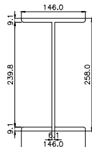
DETALLE 2 VIGA IR 254mmx32.9kg/m
