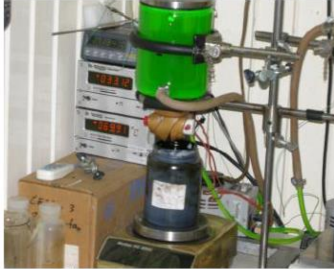
Figura 3.12 – Celda de medición para la evaluación del índice de fluidez de una mezcla de aceite con producto químico (Cruz-Andrade et al., 2014).
