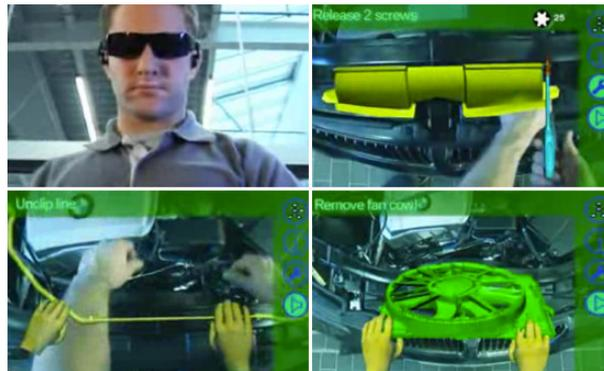
**Figura 1 Aplicación de BMW de realidad aumentada para servicio técnico [2]**
