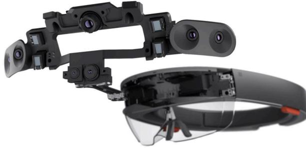
Figura 10 Arreglo de sensores y cámaras de Hololens [22]
