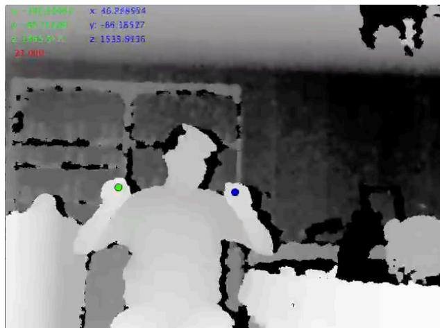
Figura 36 Obtención, muestra, y dibujo de coordenadas de manos de usuario
