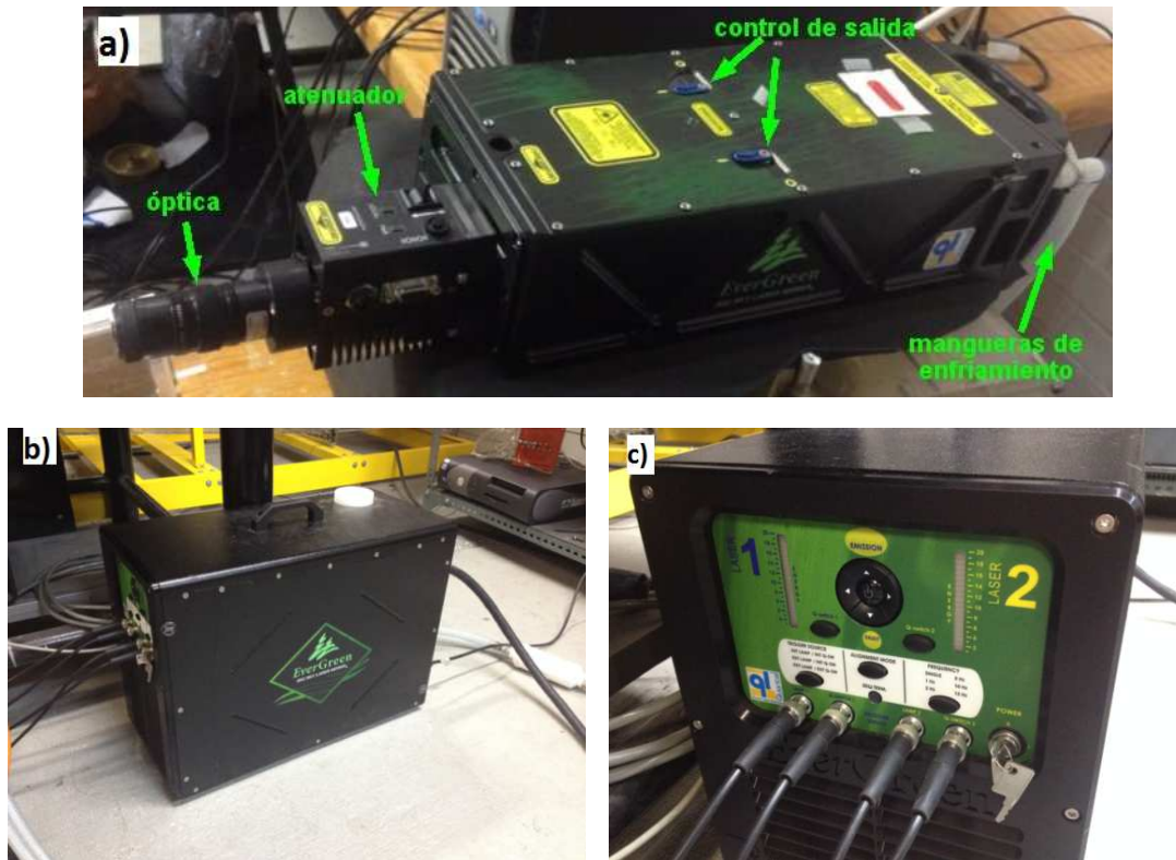
Figura 2.19: Equipo de láser. a) Cuerpo del láser, b) Unidad de enfriamiento y control electrónico, c) Detalle de unidad de enfriamiento y control electrónico. Elaboración propia.
