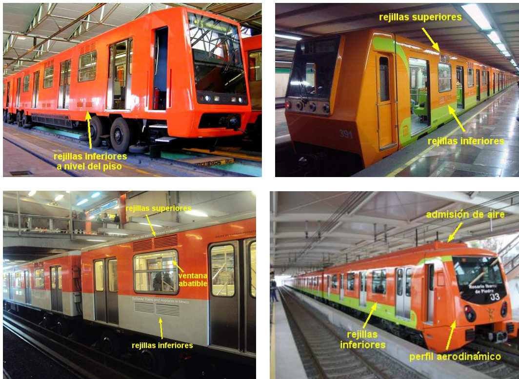
Figura 1.5: Diferentes modelos de trenes del STC metro. Obsérvese los elementos del sistema de ventilación de cada uno: ventanas, rejillas, puertas. Primera fila de arriba hacia abajo: MP-68R96C (izquierda), adaptada de STC (s.f.); MP-82 (derecha), adaptada de Inoyamanaka79 (2010). Segunda fila: NM-02 (izquierda), adaptada de picssr.com (sf); FE-10 (derecha), adaptada de GAED (2012).
