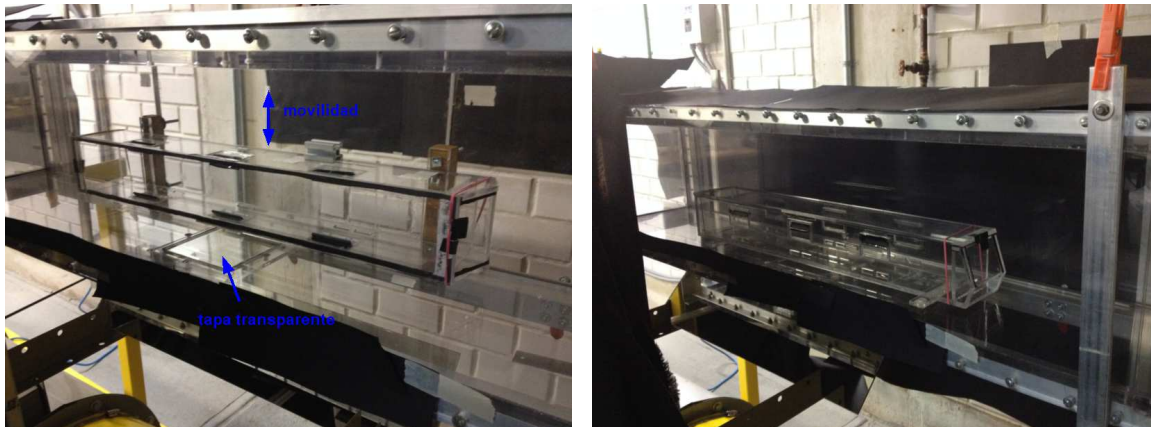
Figura 2.23: Modelo dentro del túnel de viento. Izquierda: modelo acostado soportado en compuerta lateral, pegado a la pared inferior. Derecha: modelo en configuración horizontal (plano D) al centro. Elaboración propia.
