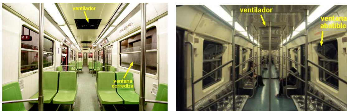
Figura 1.6: Interior de algunos vagones del STC metro. Izquierda: interior de tren modelo NC-82 con ventanas corredizas, adaptada de Arau et al. (2012); Derecha: NM-02 al interior con ventanas abatibles y pasillo intercomunicado, adaptada de picssr.com (2012).
