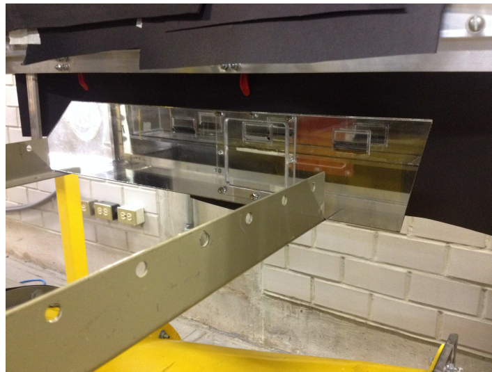
Figura 2.15: Espejo. Dimensiones: 53 \times 12 cm y espesor de 3 mm . Elaboración propia.
