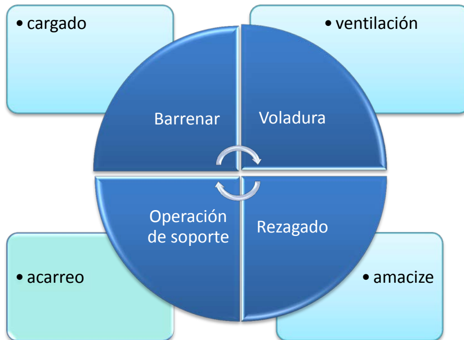
Figura 1 Ciclo convencional de minado en mina subterránea
