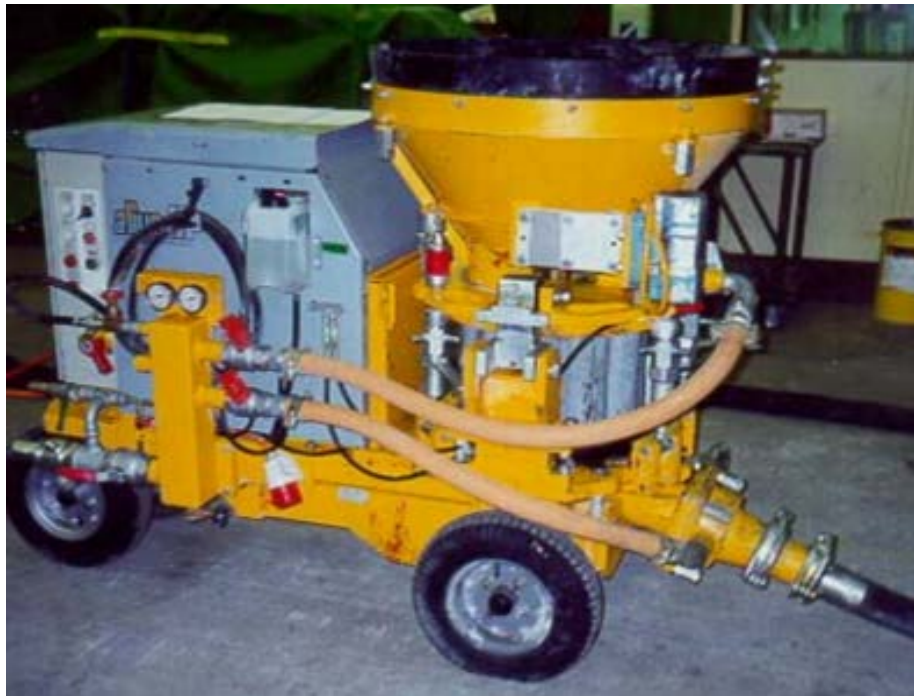
Figura 16: Máquina lanzadora Aliva 263, Sika 2015
