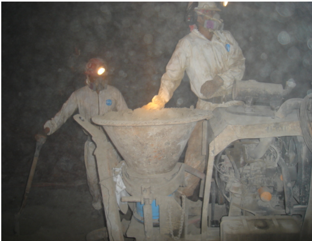
Figura 17: Allentown piccola en interior mina junto a personal lanzador (Fotografía tomada en 2013)
