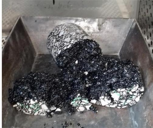
**Fig. 3-43.** Disgregado de los cilindros de concreto asfáltico durante dos horas a 100 °C
