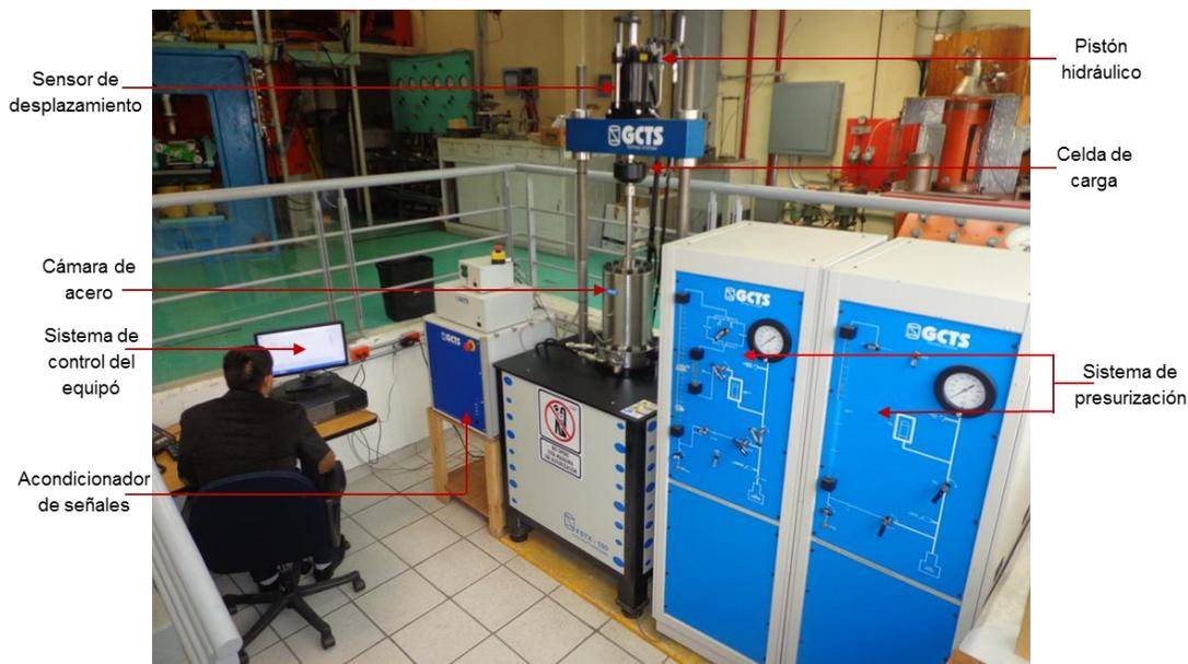
Fig. 3-20. Equipo para ensayos de compresión triaxial.
