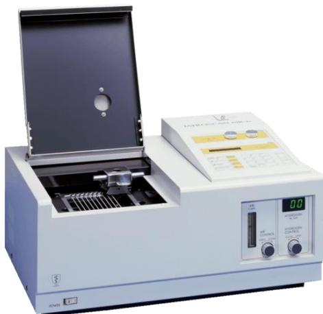
**Fig. 3-47.** Equipo IATROSCAN MK-6s<sup>®</sup>, utilizado para determinar las fracciones SARA del asfalto.
