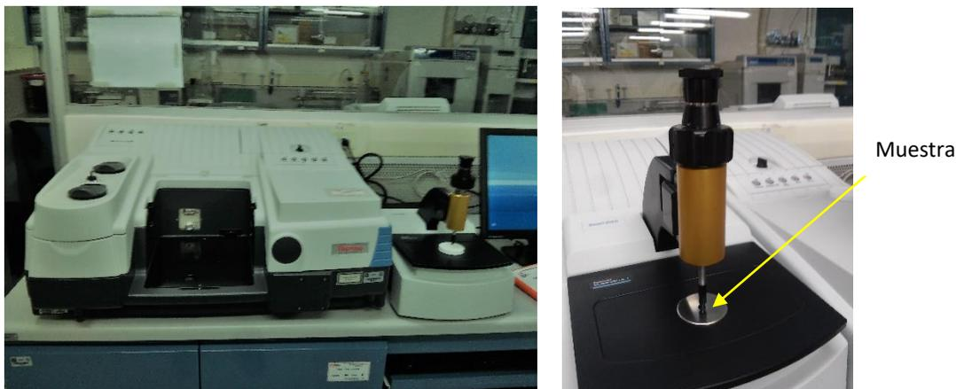
Fig. 3-50. Equipo NICOLET 6700 para efectuar análisis FT-IR.
