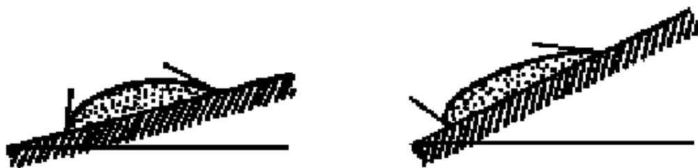
Figura 1.16 Gota sobre plato inclinado mostrando la histéresis de ángulo de contacto, (Salegar, 1993).
