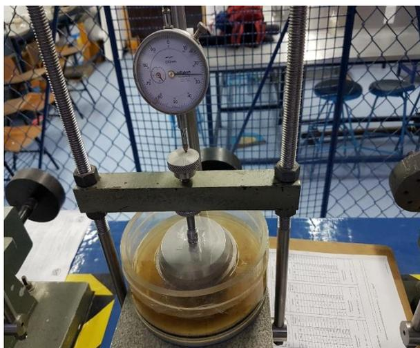
*Figura 40 Montaje del consolidómetro*
