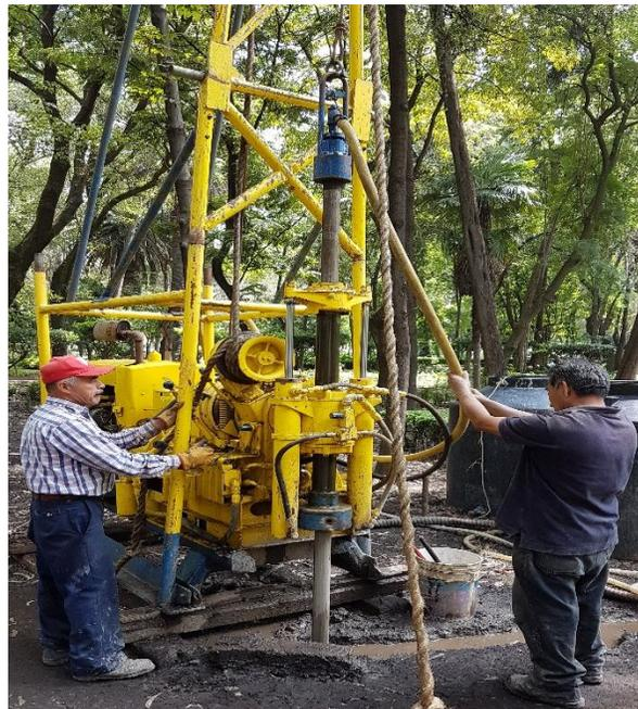
*Figura 13 Perforación con tubo Shelby*
