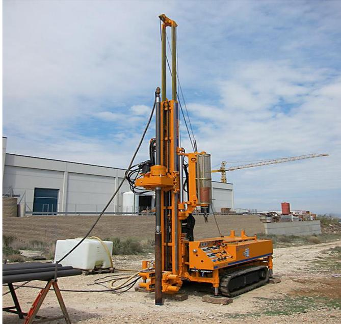
Figura 12 Perforación con penetrómetro estándar
