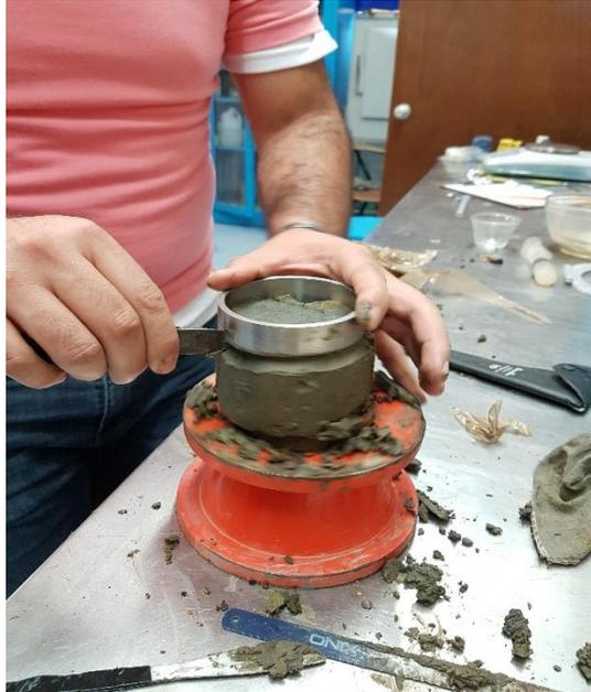
*Figura 37 Introducción del anillo a la muestra*
