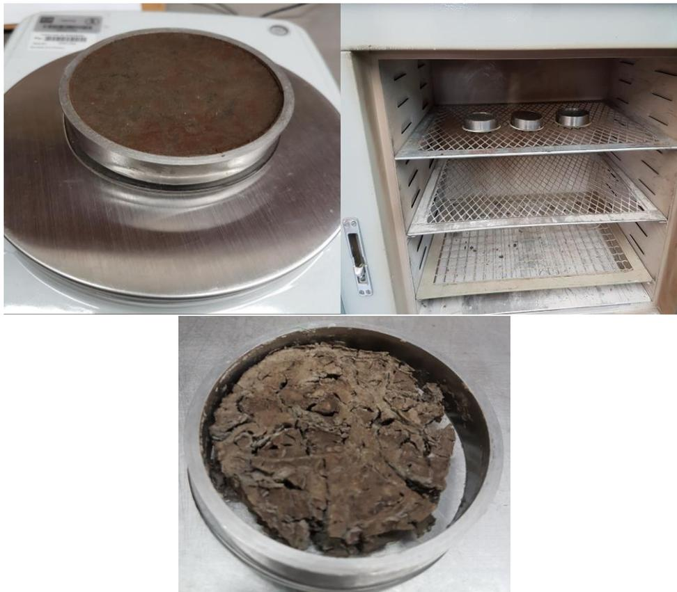
*Figura 42 Desmonte de la probeta y obtención del peso seco*
