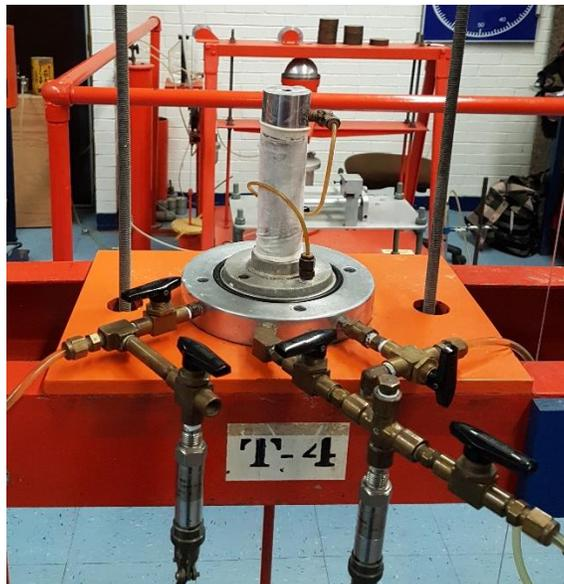
*Figura 46 Montaje de la probeta*
