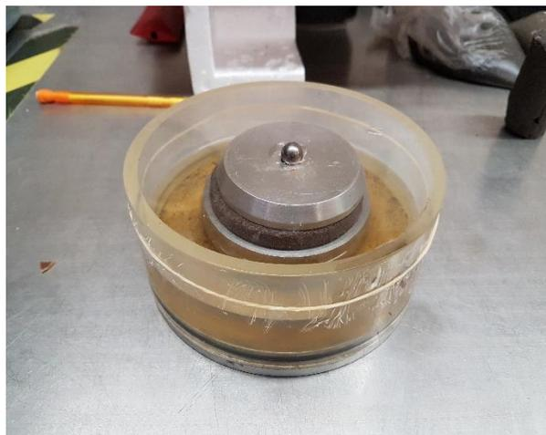
*Figura 39 Encapsulado de probeta de suelo*
