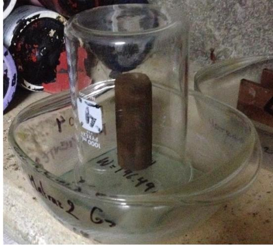
*Figura 45 Probeta en cuarto húmedo para evitar perdida de humedad*
