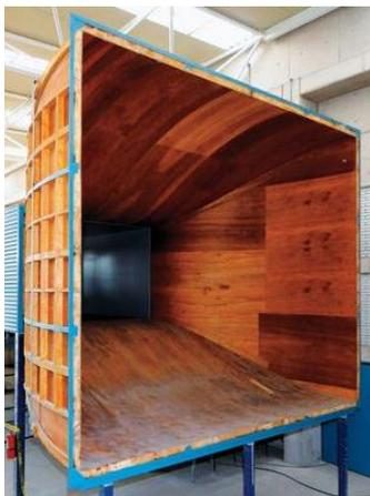
Figura 4. Cono de contracción de madera del túnel de viento LemAT.
