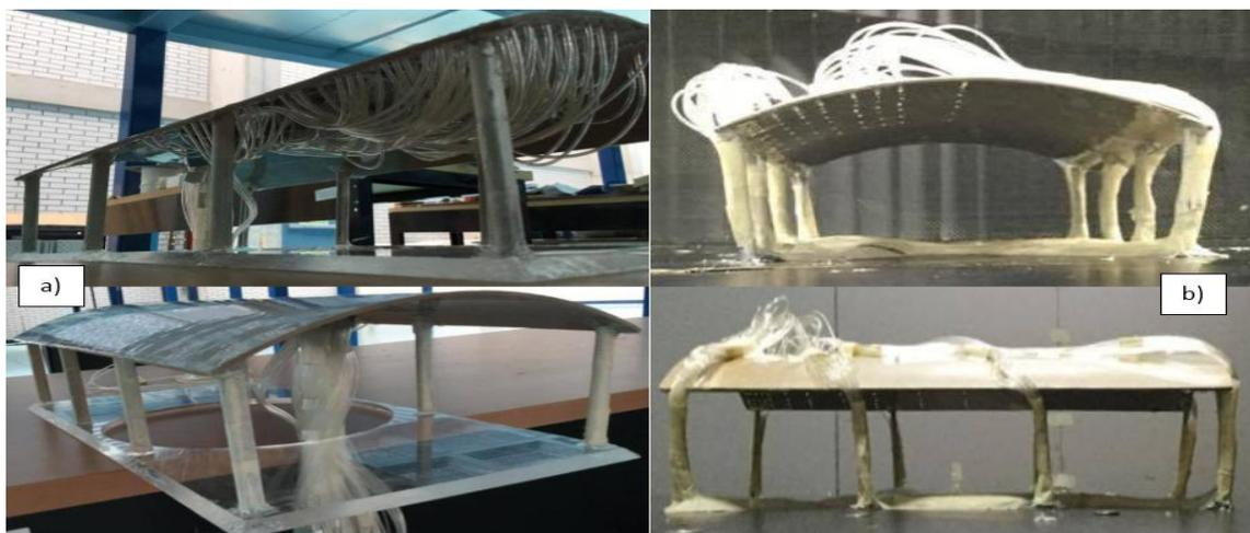
Figura 38. Instrumentación de modelo de nave industrial arco - columna para a) presiones exteriores y b) presiones interiores
