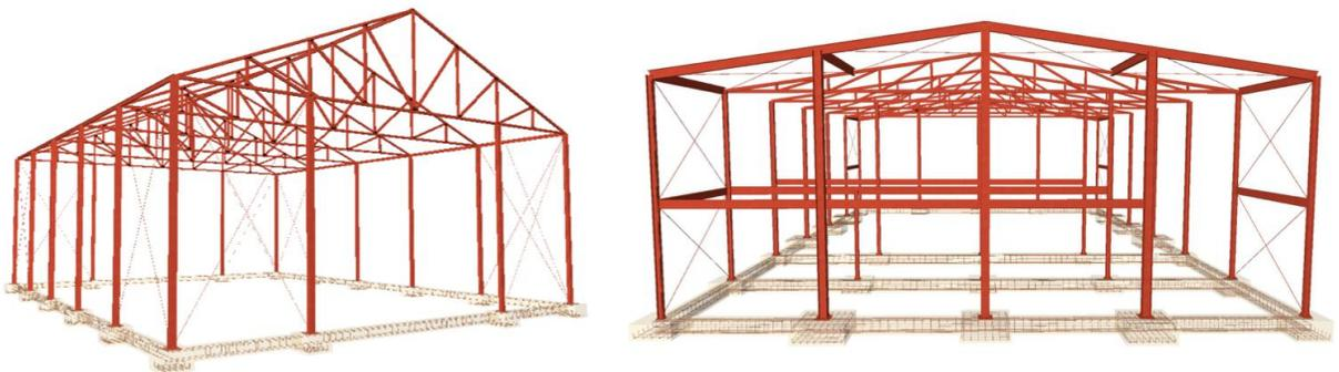
Figura 22. Geometría de nave industrial con cubierta a dos aguas (Sitio web)
