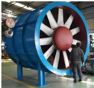
Figura 1. Ventilador para Túnel de Viento (Sitio Web)
