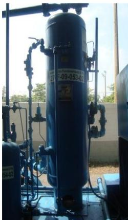
Figura 4.18. Separador vertical del equipo no convencional.
