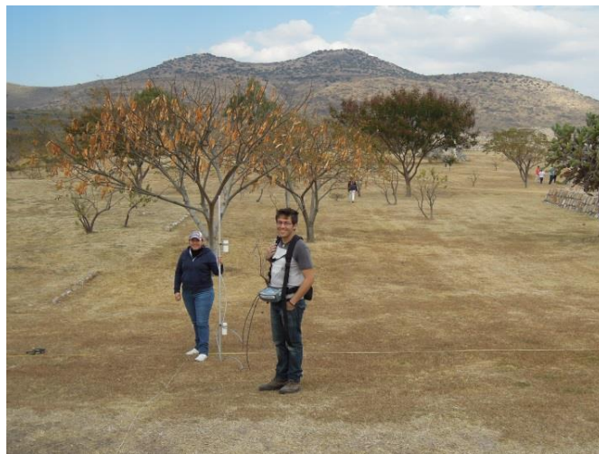
Figura 8. Magnetómetro G-858 Geometrics, durante una de las mediciones
