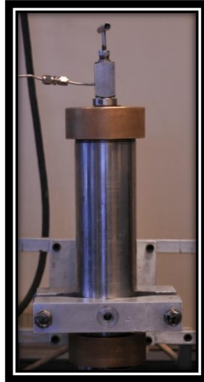
Figura 4.3. Cilindro de Transferencia.
