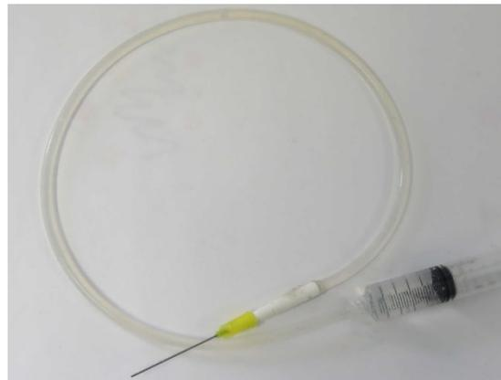
Figura 76. Fotografía de la conexión entre la jeringa y el capilar es de silicona flexible.
