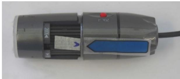
Figura 89. Fotografía de la cámara con marcas para indicar la posición donde se observa claramente la gota formada a la salida del capilar.
