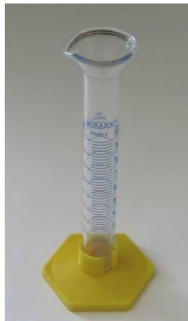
Figura 88. Probeta empleada para medir el volumen de fluido bombeado.
