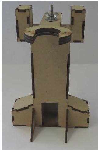
*Figura 90. Fotografía del soporte para la cámara USB adaptada para facilitar su ajuste.*
