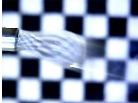
*Figura 106. Fotografía del momento en que la fuerza del campo eléctrico vence la viscosidad y la tensión superficial de la gota.*
