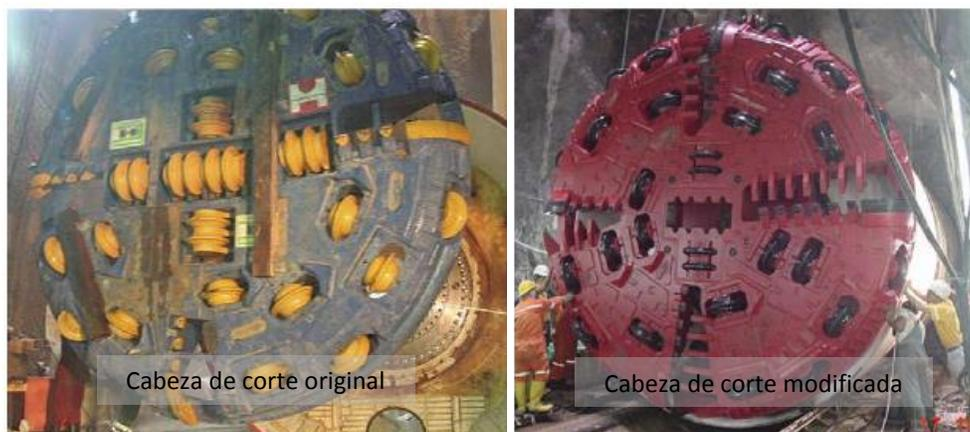
Figura 3.5 Cabeza de corte de la tuneladora antes y después de la modificación. (Zhao et al., 2007)
