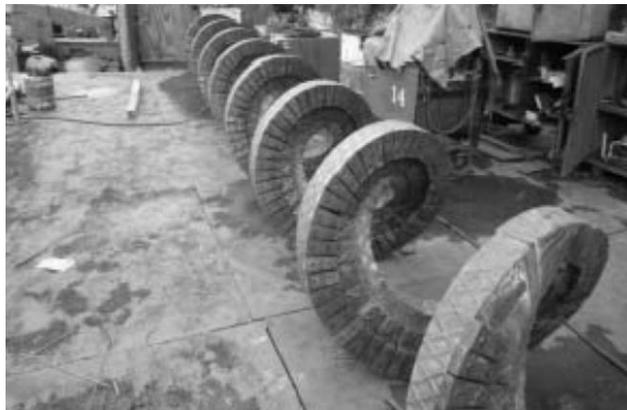
Figura 3.16 Tornillo sin eje tipo Ribbon. (Lombardo, y Pérez, 2014)
