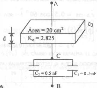
SOLOCIÓN. a) PRIMERO SE DETERMINA EL VALOR DEL CAPACITOR  $C_3$  MEDIANTE LA EXPRESIÓN:
