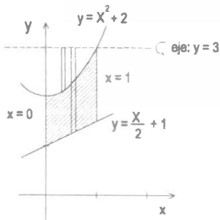
PARA CALCULAR EL VOLUMEN, SE DEBE EFECTUAR LA RESTA DE DOS VOLÚMENES: EL QUE SE GENERA AL GIRAR ALREDEDOR DEL EJE LA SUPERFICIE LIMITADA POR ÉSTE Y LA RECTA, MENOS EL GENERADO AL GIRAR SOBRE DICHO EJE, LA SUPERFICIE LIMITADA POR ÉL Y POR LA PARÁBOLA. SI AMBOS VOLÚMENES SE CONSIDERAN EN LA MISMA INTEGRAL DEFINIDA SE TIENE QUE:
