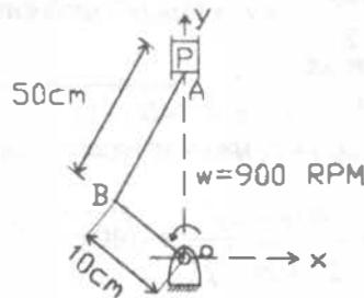
PARA ESTE PROBLEMA SE ACEPTARÁ LA INTERPRETACIÓN (A). SI EL MOTOR GIRA CON UNA VELOCIDAD ANGULAR DE 900 RPM Y LAS DIMENSIONES SON LAS DE LA FIGURA, CALCULAR LA VELOCIDAD DEL PISTÓN CUANDO EL PUNTO "B" SE ENCUENTRA SOBRE EL EJE DE LAS ABCISAS.
