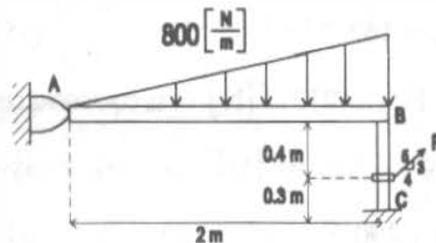
SOLUCIÓN. LA CARGA DISTRIBUIDA TRIANGULAR ES EQUIVALENTE A UNA SÓLA FUERZA CON MAGNITUD F IGUAL AL ÁREA DEL TRIÁNGULO DE LA FIGURA, APLICADA A LOS  $2/3$  DE LA DISTANCIA ENTRE A Y B ASÍ,
