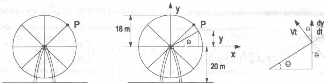
SOLUCIÓN. LA VELOCIDAD ANGULAR DE LA RUEDA ESTÁ DADA POR  $\omega = \frac{d\theta}{dt} = \frac{1.5(2\pi) \text{ rad}}{2 \text{ min}} = 1.5 \pi \frac{\text{rad}}{\text{min}}$  Y, DE ACUERDO CON LA FIGURA EN LA QUE SE
