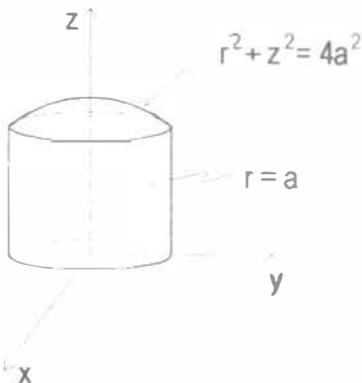
SE UTILIZARÁN COORDENADAS CILÍNDRICAS. COMO LA DENSIDAD EN EL PUNTO  $P(r, \theta, z)$  ES DIRECTAMENTE PROPORCIONAL A LA DISTANCIA DEL PUNTO AL PLANO XY, ENTONCES SE PUEDE EXPRESAR COMO  $\rho = kz$ , DONDE "k" ES LA CONSTANTE DE PROPORCIONALIDAD. ENTONCES LA MASA "M" PUEDE SER CALCULADA MEDIANTE LA INTEGRAL TRIPLE:
