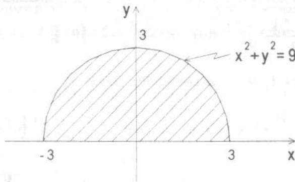
COMO SE OBSERVA EN LA FIGURA, SE TRATA DE UN SEMICÍRCULO Y, SI ADEMÁS SE TOMA EN CUENTA QUE EL INTEGRANDO CONTIENE LA SUMA DE LOS CUADRADOS DE "x" Y DE "y", SE VE LA CONVENIENCIA DE CAMBIAR A COORDENADAS POLARES, DONDE EL FACTOR DE CAMBIO, DE ACUERDO A LO ESTUDIADO EN SISTEMAS DE COORDENADAS CURVILÍNEAS, ES "r". ADEMÁS, PARA FIJAR LOS NUEVOS LÍMITES DE INTEGRACIÓN, SE VE CÓMO VARIAN LAS VARIABLES r Y  $\theta$ . ASÍ, SE TIENE QUE:
