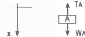
$$\sum F_x = m a_A \Rightarrow W_A - T_A = \frac{W_A}{g} a_A \dots (1) \text{ Y, DADO QUE } T_A = 2T_B \dots (2) \text{ y } a_B = 2a_A \dots (3).$$
