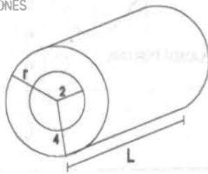
DE LA LEY DE GAUSS, LA CARGA ENCERRADA EN EL CILINDRO ES  $Q_{\text{enc}} = \int_S \vec{D} \cdot d\vec{s}$  POR LO QUE PUEDE COMPROBARSE QUE  $\vec{D} = \frac{Q}{A} \hat{r}$ , DONDE 'A' ES
