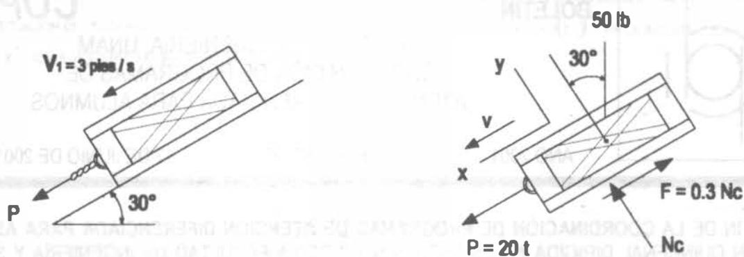
DIAGRAMA DE CUERPOLIBRE. OBSÉRVESE LA SEGUNDA FIGURA COMO LA MAGNITUD DE LA FUERZA  $P = 20t$  VARÍA CON EL TIEMPO. ES PRECISO DETERMINAR EL IMPULSO POR INTEGRACIÓN EN EL INTERVALO DE TIEMPO DE  $2s$ . EL PESO, LAS FUERZAS NORMAL Y DE FRICCIÓN (QUE ACTÚAN EN DIRECCIÓN OPUESTA A LA DEL MOVIMIENTO) SON CONSTANTES, DE MODO QUE EL IMPULSO QUE ORIGINA CADA UNA DE ESTAS FUERZAS ES SIMPLEMENTE LA MAGNITUD DE LA FUERZA MULTIPLICADA POR  $2s$ .
