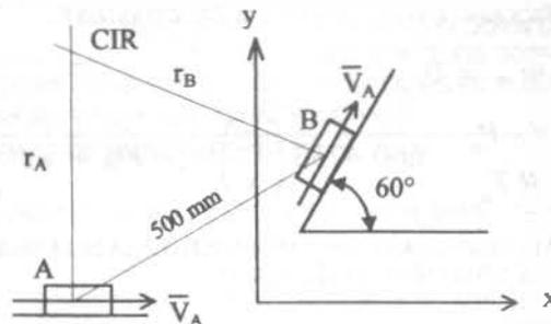
EN ESTA FIGURA SE OBSERVA QUE LA BARRA Y LAS LÍNEAS " $r_A$ " Y " $r_B$ " FORMAN EL TRIÁNGULO  $ABCIR$ , EL CUAL ES EQUILÁTERO; POR LO TANTO:
