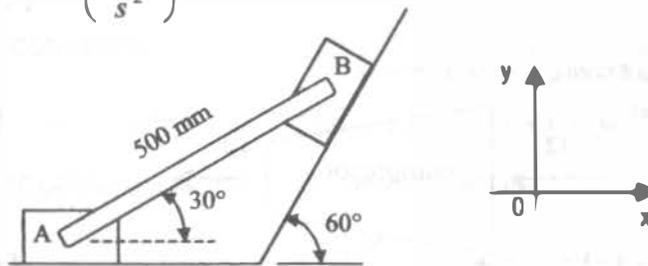
SOLUCIÓN. PARA DETERMINAR LA VELOCIDAD DEL BLOQUE "A" ( $\vec{v}_A$ ) Y LA DEL BLOQUE "B" ( $\vec{v}_B$ ), SE APLICARÁ EL CONCEPTO DE CENTRO INSTANTÁNEO DE ROTACIÓN (CIR)
