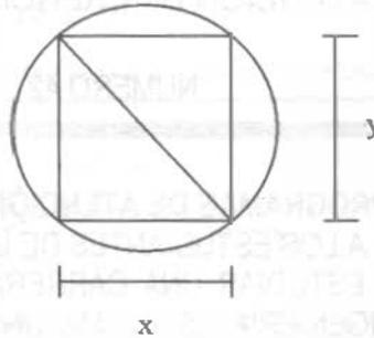
A) LA FUNCIÓN OBJETIVO A OPTIMIZAR ES EN ESTE CASO:  $R_C = k xy$  Y DE LA FIGURA SE OBTIENE UNA RELACIÓN ENTRE EL ANCHO Y EL PERALTE DE LA SECCIÓN, MEDIANTE EL TEOREMA DE PITÁGORAS, DE LA QUE SE DESPEJA UNA VARIABLE, SE SUSTITUYE EN LA FUNCIÓN OBJETIVO Y SE RESUELVE EL PROBLEMA PLANTEADO. ASÍ SE TIENE QUE:
