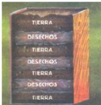
Figura 3.2 Composición de un contenedor compostador y tubería de aireación
