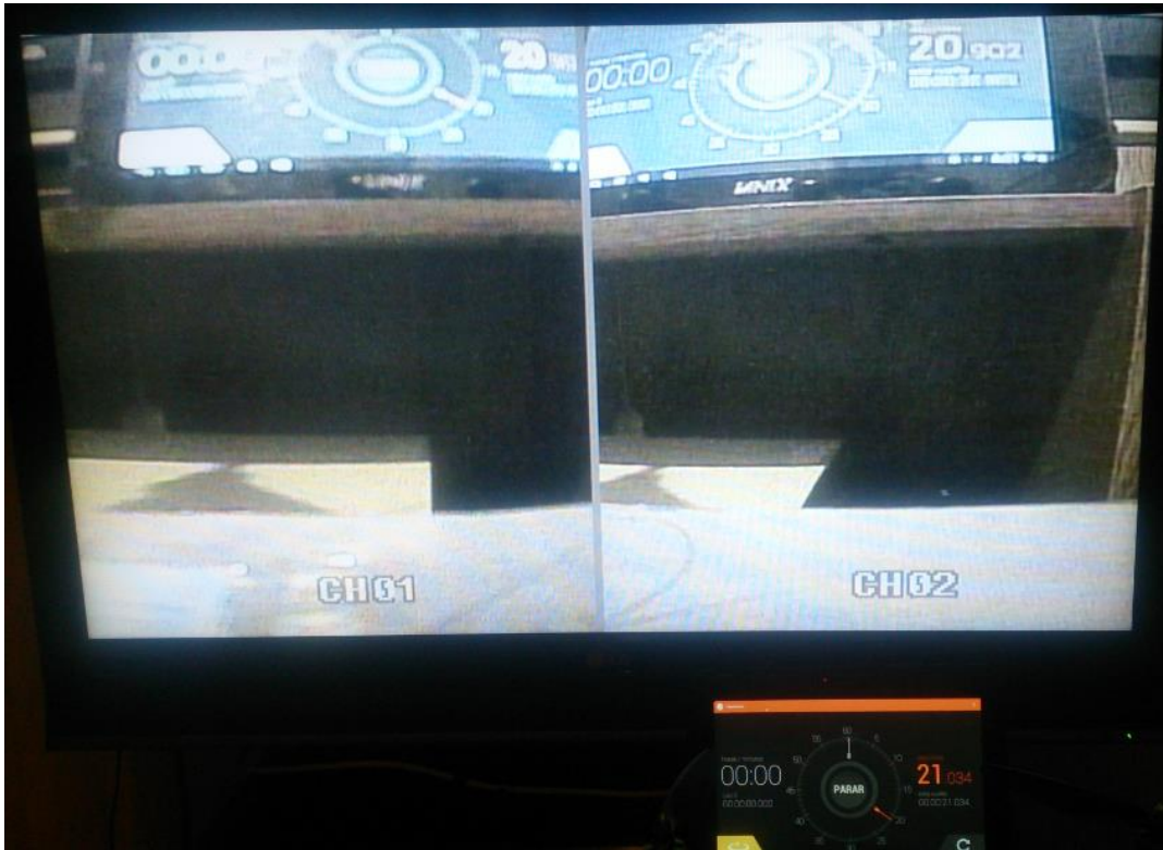
Figura 75. Prueba de latencia en el video.
