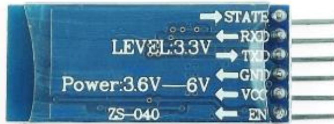
Figura 61. Módulo bluetooth Hc-05 [70].
