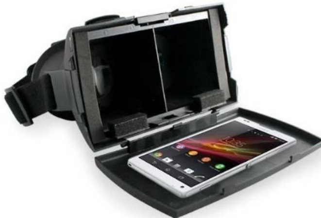
Figura 20. Lentes de realidad virtual para smartphone [33].
