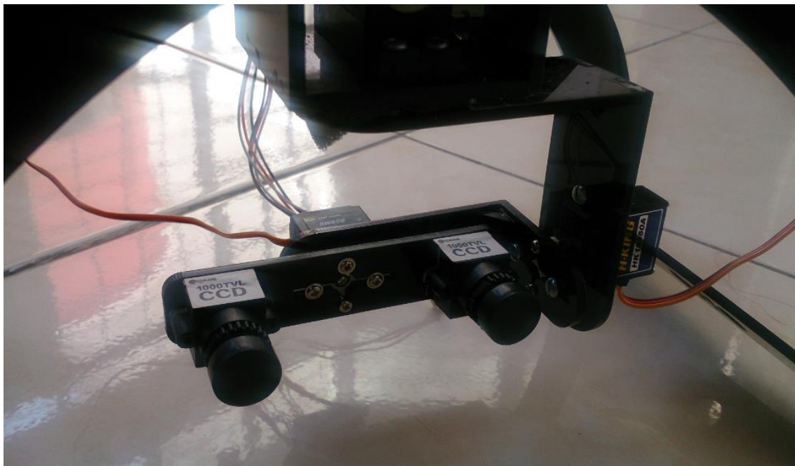
Figura 69. Gimbal para visión estereoscópica en primera persona. El gimbal se diferencia de la mayoría de los que se encuentran comercialmente, por poseer dos cámaras, que transmiten su video por dos canales de radiofrecuencia distintos.
