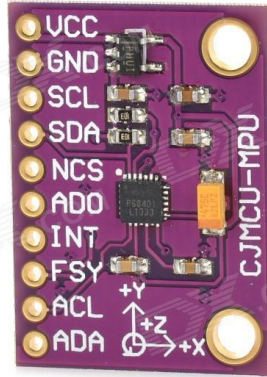
Figura 34. Módulo CJMCU-MPU, IMU de 9 ejes [58].
