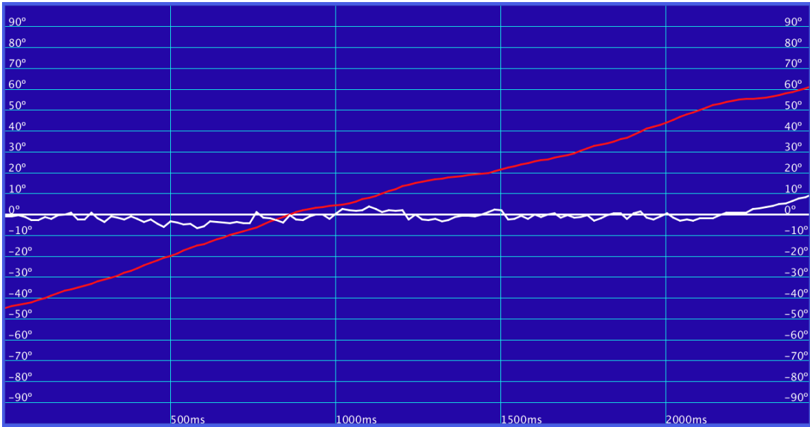
Figura 82. Compensación en pitch para una rotación de cerca de 90°, en aproximadamente 2 segundos. En la gráfica se observa un error máximo menor a 10°.
