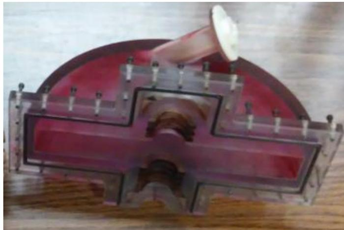
Figura 3. 2 Carcasa de la turbina (IIDEA)
