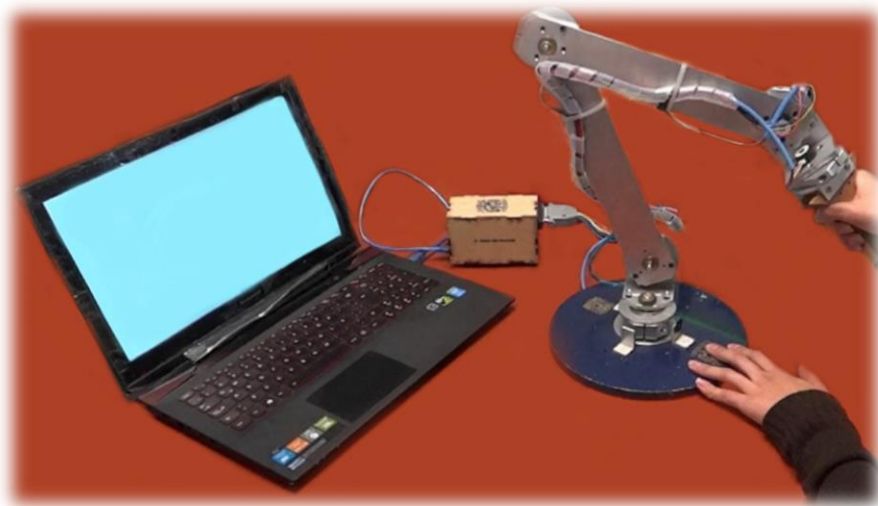
Figura 64. Conexión del mecanismo al Arduino DUE y a la computadora
