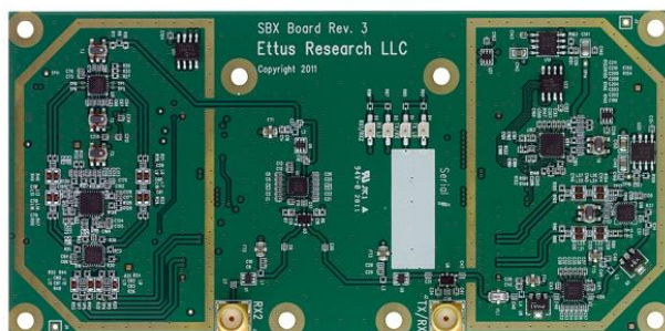
Fig 4.4 Tarjeta hija SBX 400-4400 MHz Rx/Tx (40 MHz) [39].
