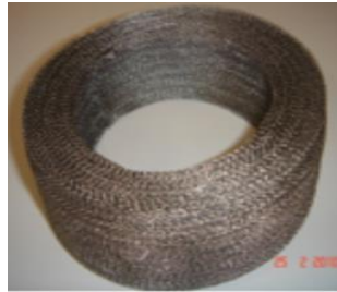
Figura 2.14 Regenerador de acero inoxidable 304L [43].
