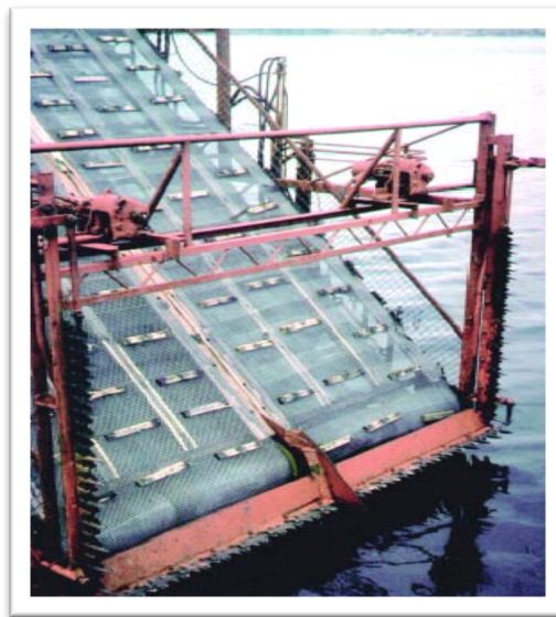
Figura 1.10 Cortadores montados en la parte frontal de un buque para la recolección de Macrocystis pyrifera
