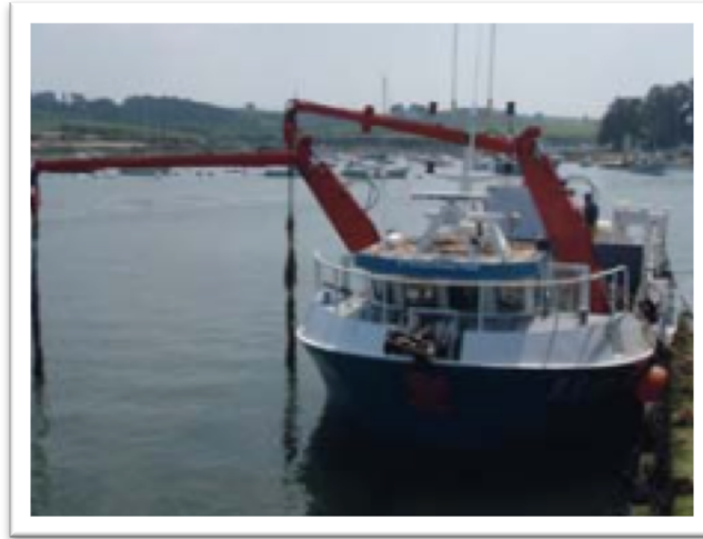
Figura 1.8 Barco recolector Scoubidou de Laminaria digitata en las costas de Brittany, Francia.
