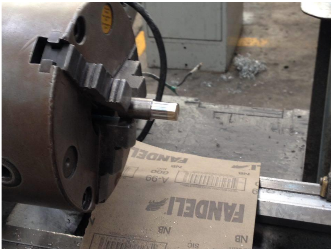
Fig. 2.15. Lijado en la parte cilíndrica del electrodo (pieza montada en torno).
