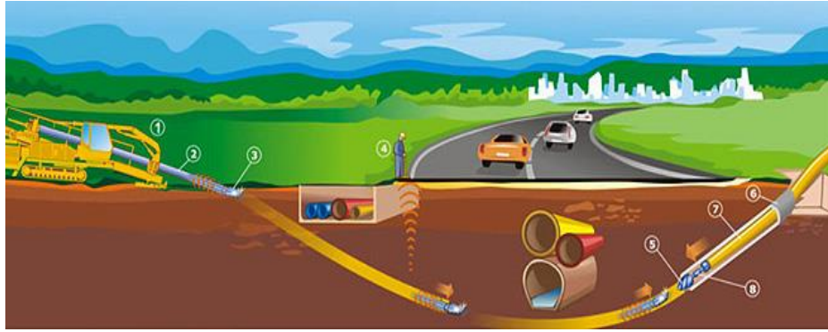
Figura 10 Funcionamiento de una perforación dirigida. Fuente: Universidad Politécnica de Valencia (2001)
