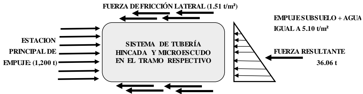
Esquema de fuerzas actuantes en el cuerpo de la tubería y frente de excavación
