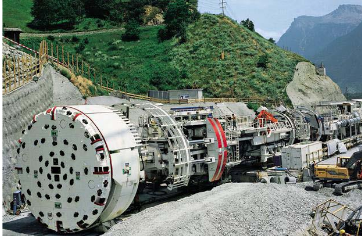
Figura 16 Máquina topo. Fuente: Herrenknecht AG
