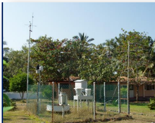
Figura 4. 3.- Sistema de muestreo del depósito atmosférico, marca Aerochem Metrics, Modelo 301.
