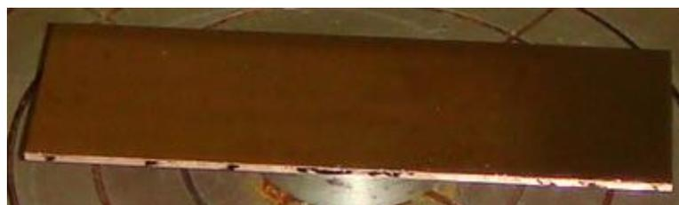
Figura 2.12. Sustrato de vidrio con una capa de cobre depositada.
