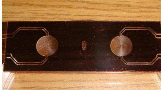
Figura 2.15. Sensor tipo espiral depositado sobre un sustrato de vidrio después del ataque con cloruro férrico.
