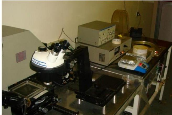
Figura 2.13. Equipo utilizado para el proceso de litografía. Podemos observar el spin-coating y la cámara de explosión a UV.
