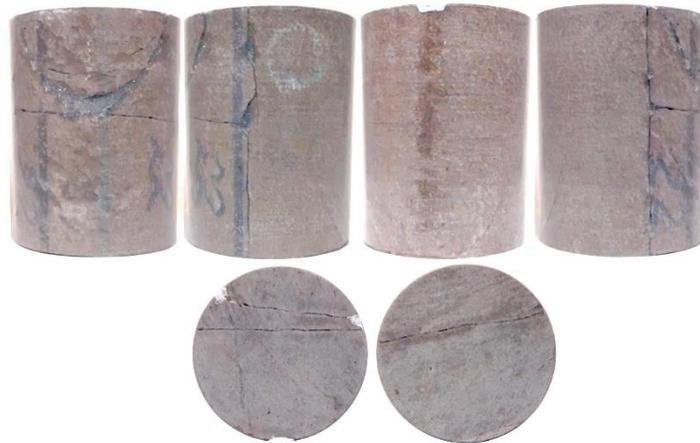
Figura 64. Núcleo Naturalmente Fracturado acondicionado para prueba de desplazamiento
