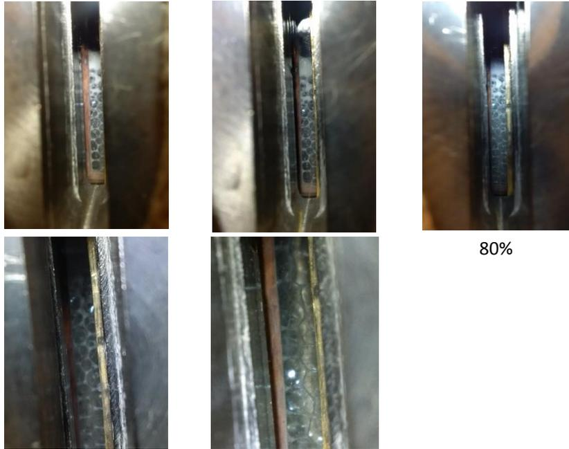
Figura 31. Espuma generada con calidad del 80%
