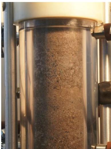
Figura 57. Sistema saturado con Salmuera
