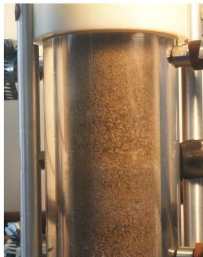
Figura 58. Sistema con emulsión en proceso de inversión de fase
