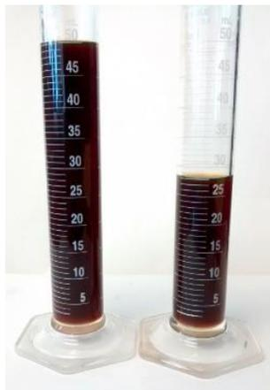
Figura 66. Recuperado por desplazamiento de aceite
