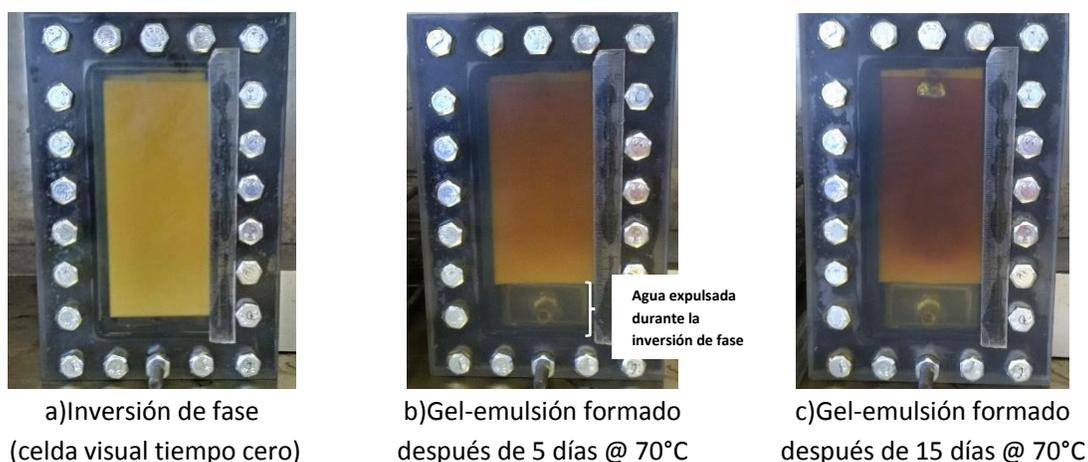
Figura 43. Proceso de inversión de fase, generación de gel-emulsión
