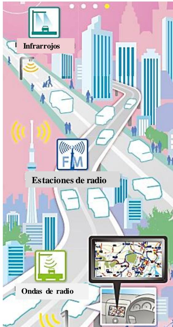
**Figura 2.4. Funcionamiento sistema avanzado de gestión del transporte Japón**
