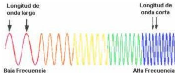
**Figura 3.11. Longitud de onda y frecuencia**
