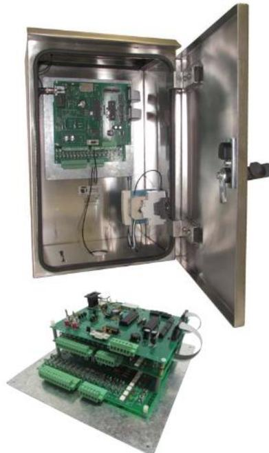
**Figura 3.59. Controlador de semáforos con sincronía con detectores vehiculares y peatonales**
