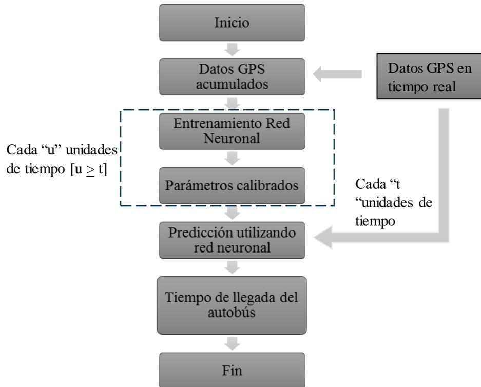
**Figura 4.19. Proceso de actualización de parámetros en el modelo de predicción en tiempo real**
