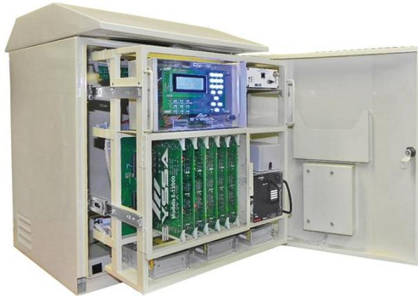
**Figura 3.60. Controlador de semáforos para múltiples intersecciones**
