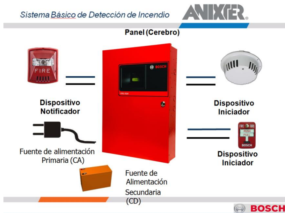
Figura 3. Componentes Básicos de Incendio
