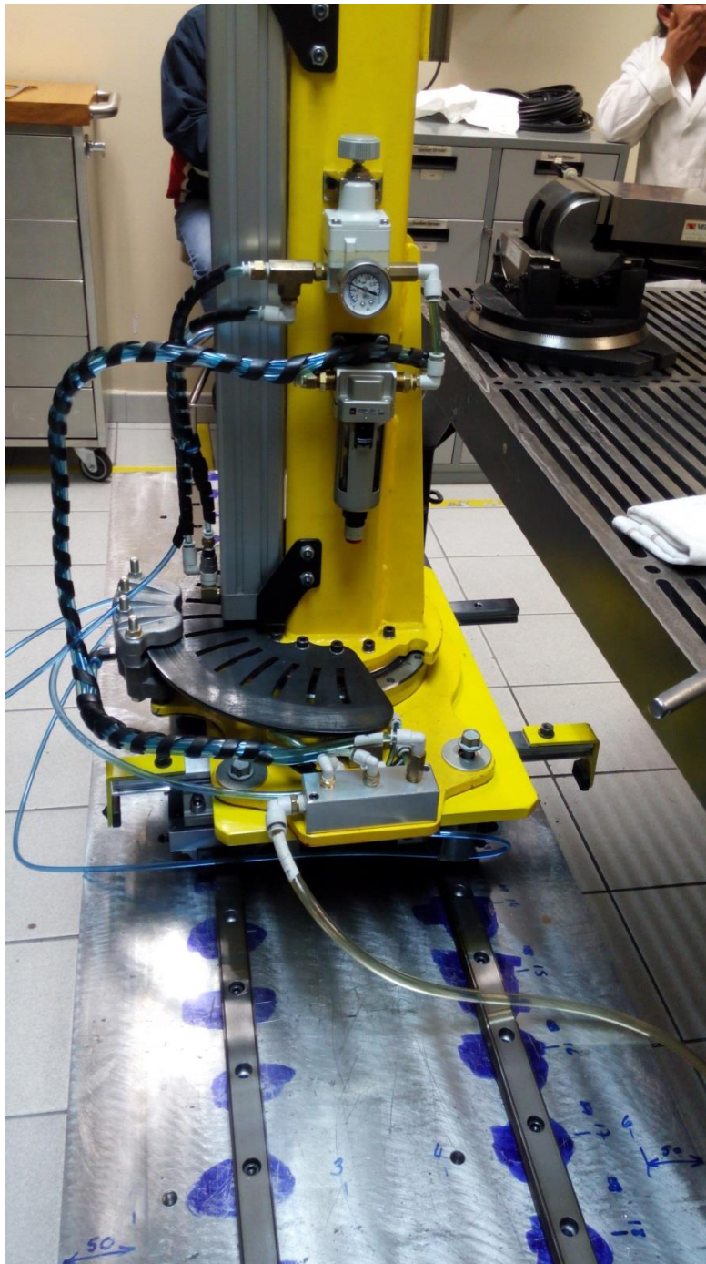
Figura 16. Ensamble preliminar [brazo de reacción sobre sistema de movimiento X-Y] a) vista lateral izquierda , b) vista lateral derecha
