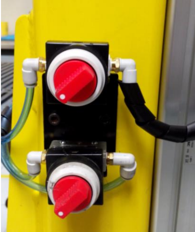
Figura 17. Sujeción de mandos que accionan los frenos neumáticos
