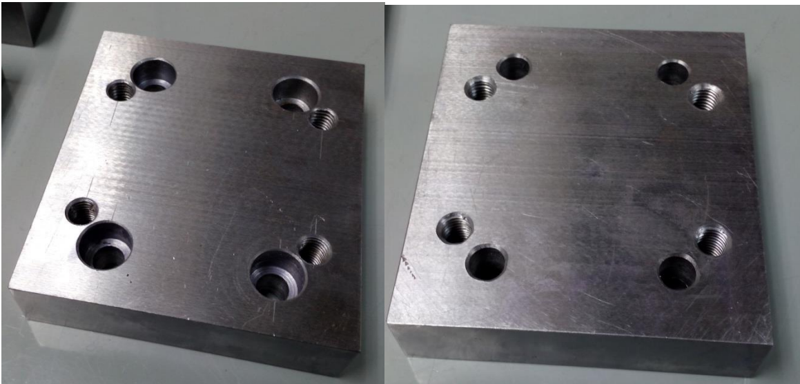
Figura 12. Placas de \frac{1}{2} " que sirven para unir ambos rodamientos lineales
