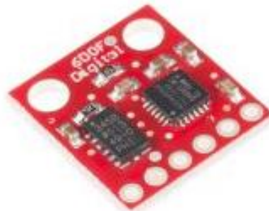
Figura 2.6. Acelerómetro ADXL345 con giroscopio ITG3200 incluido.
