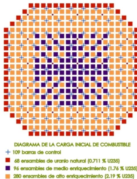
**Figura 1.10. Diagrama de una carga inicial de combustible**
