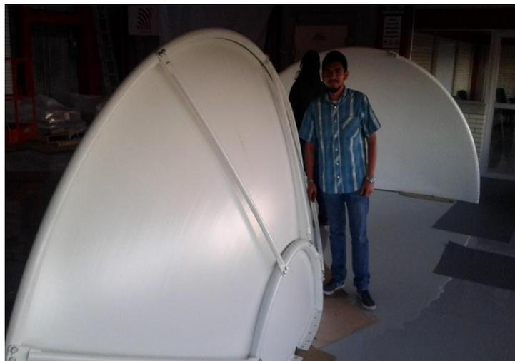
Figura 5.20 Reflector parabólico desarmado
