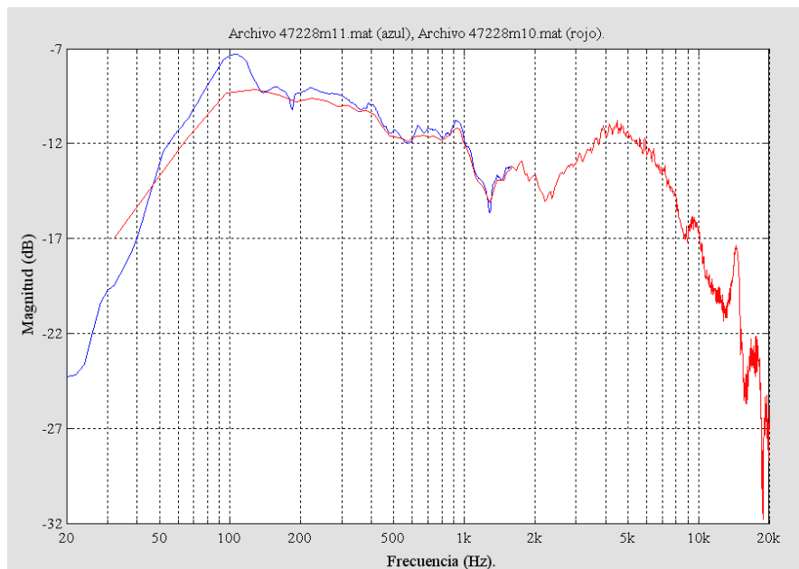
Fig. C.1: Ejemplo de respuesta en frecuencia para un ángulo de 60°.
