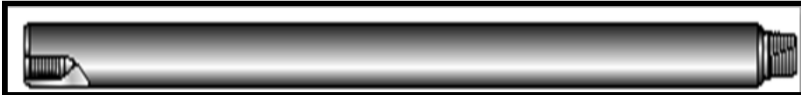
Figura 2.3 Lastrabarrenas liso. Fuente: Manual de capacitación y desarrollo de habilidades en actividades de perforación y mantenimiento de pozos. PEMEX.
