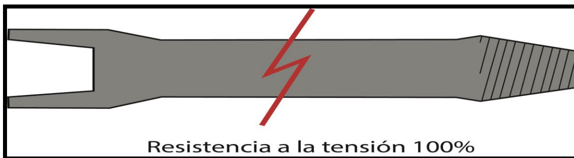
Figura 3.3 Junta del tipo recalcada. Tuberías.
