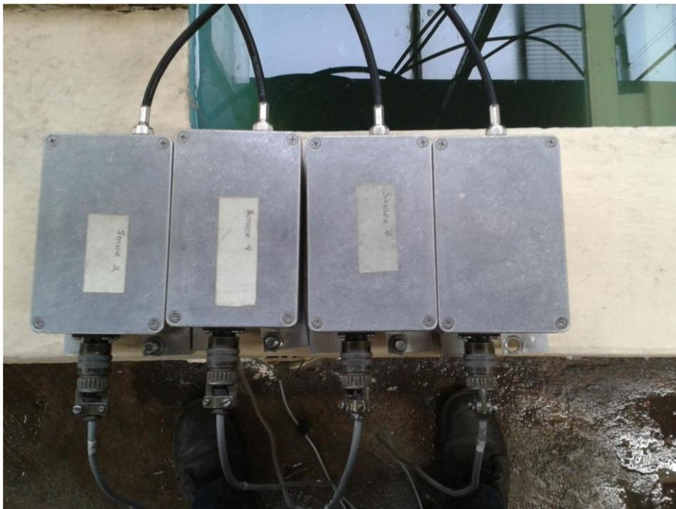
Figura 3.13 Acondicionadores que se conectan a los sensores de nivel
