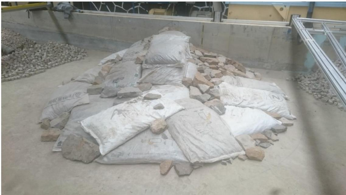
**Figura 3.25** Construcción final del núcleo girado del morro
