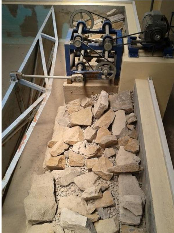
Figura 3.7 Reacomodo que forman el disipador de energía detrás de la pala generadora de olas
