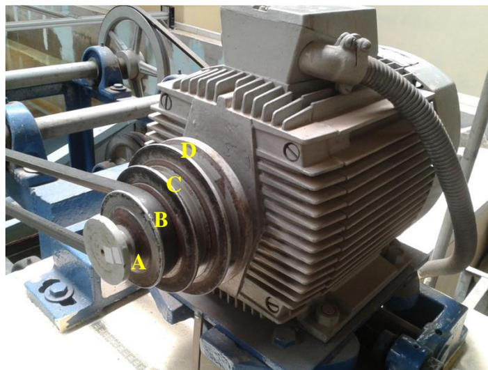
Figura 3.19 Poleas adosadas al motor eléctrico del estanque de olas
