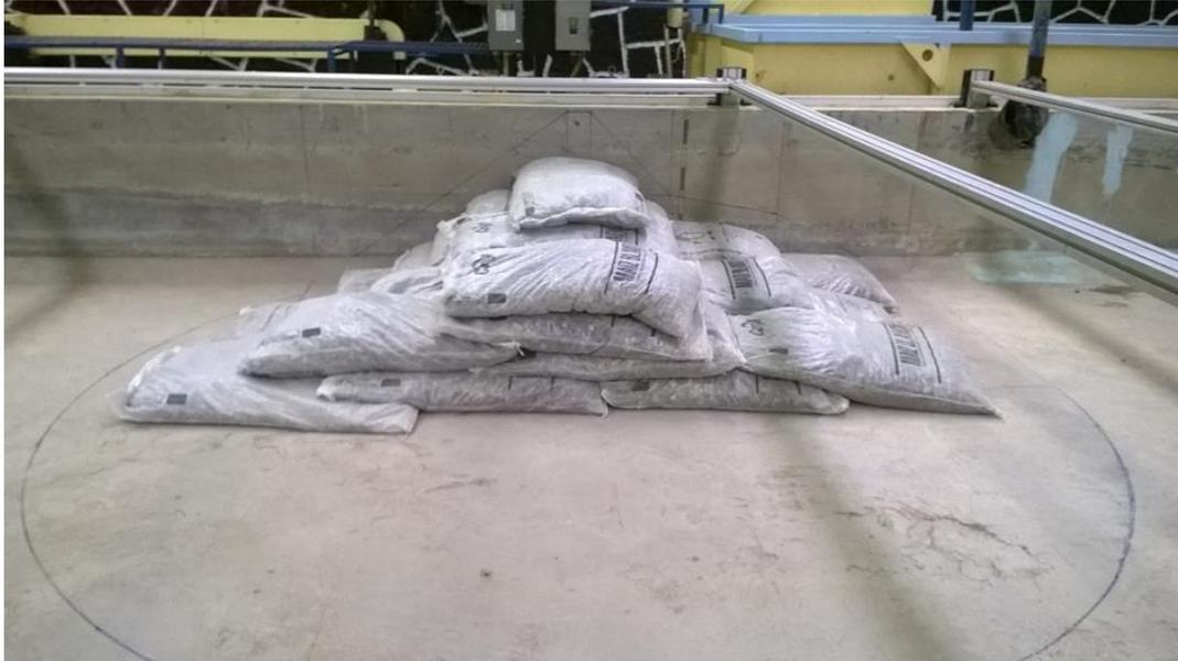
Figura 3.9 Construcción del núcleo del morro
