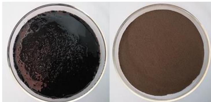
*Figura 5.1 Lodo granular anaerobio antes y después del tratamiento térmico.*
