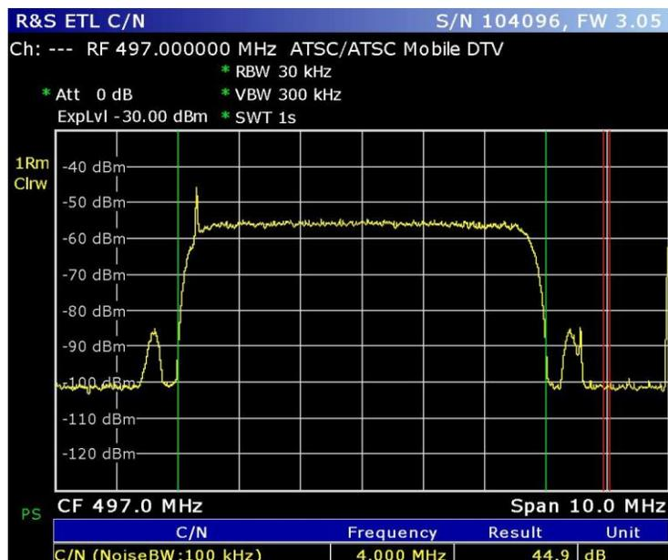
Figura 3.20. Espectro de la señal de televisión digital con una potencia de -30 dBm grabada y reproducida por el USRP con OCXO.
