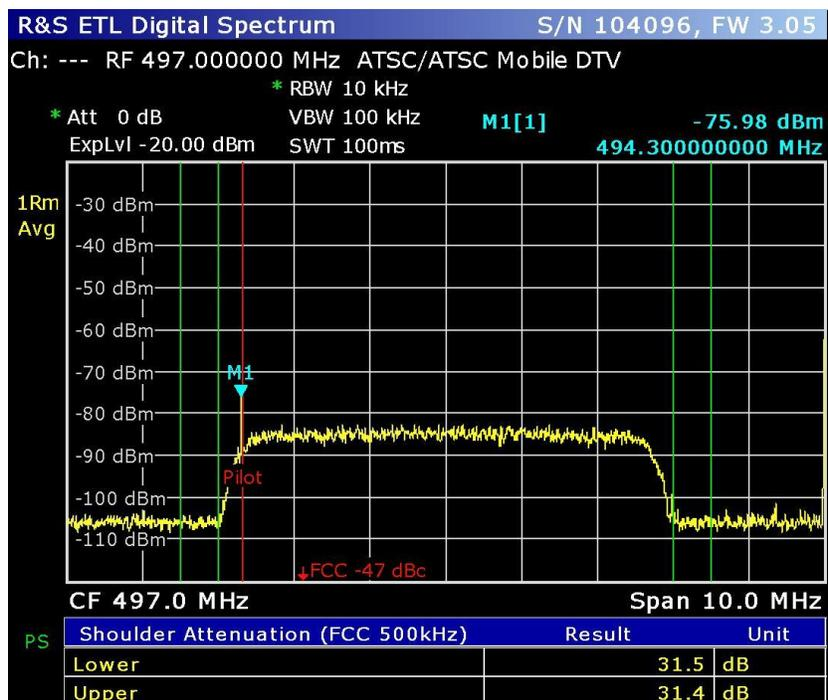
Figura 3.16. Espectro de la señal de ATSC con una potencia de -53 dBm, a una frecuencia de 497 MHz grabado con el USRP sin OCXO.
