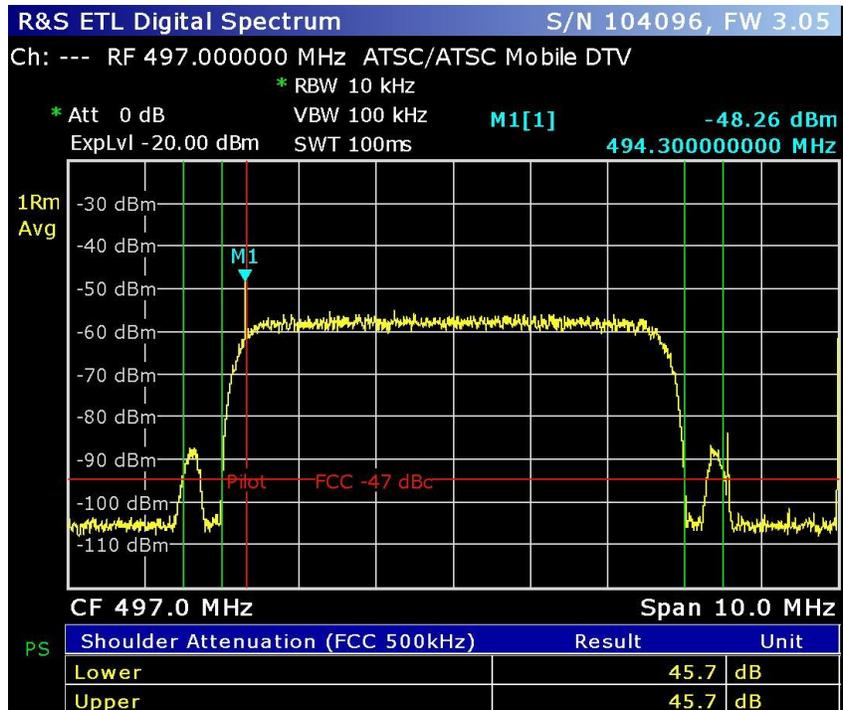
Figura 3.15. Espectro de la señal de ATSC con una potencia de -28 dBm, a una frecuencia de 497 MHz grabado con el USRP sin OCXO.
