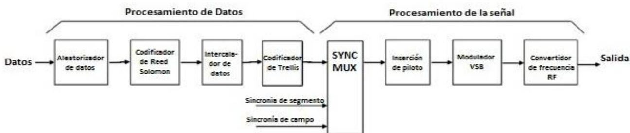
Figura 2.1. Diagrama en bloques del transmisor de ATSC [12].
