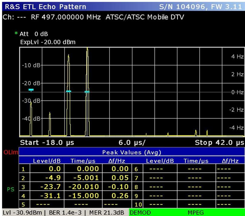
Figura 3.23. Representación de señal principal y una señal eco (pre-eco) con un retardo de 5 μs.
