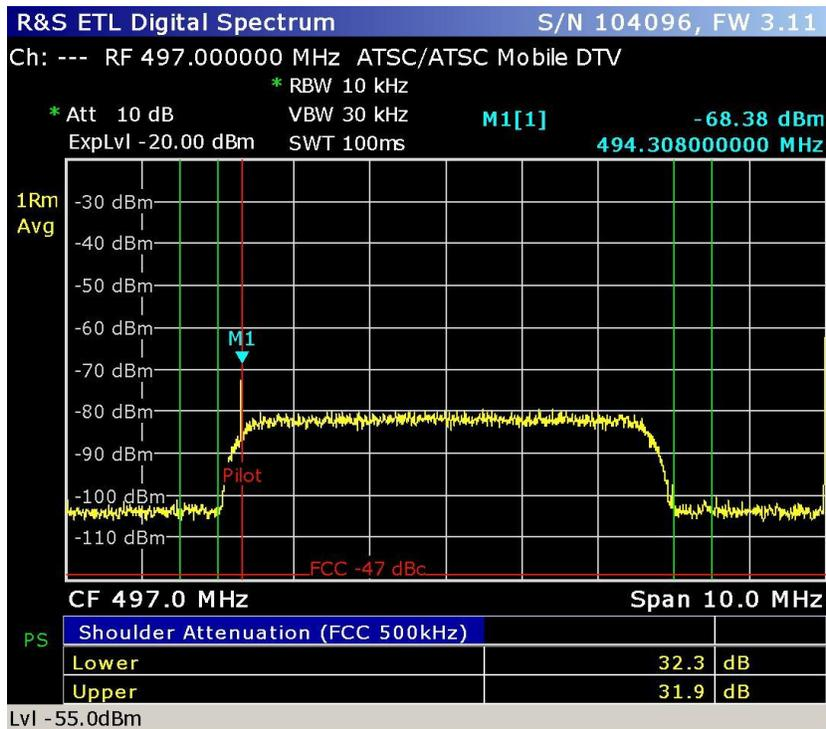
Figura 3.18. Espectro de la señal de ATSC con una potencia de -53 dBm, a una frecuencia de 497 MHz grabado con el USRP con OCXO.
