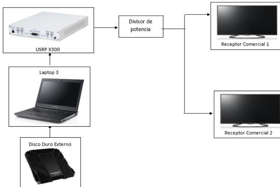
Fig. 2 Diagrama del equipamiento de medida en laboratorio
