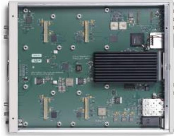
Figura 3.14. Vista superior interna del USRP X300 [3].
