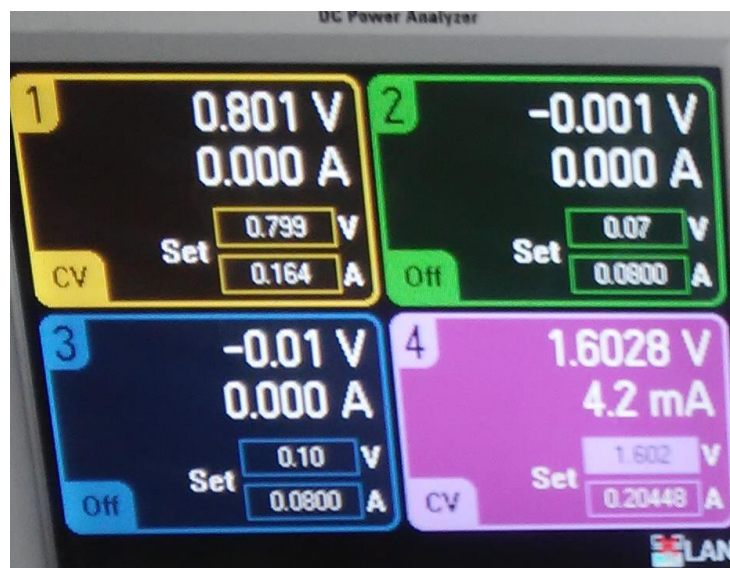
Figura 115.- Voltaje y corriente de drenaje (canal 4)
