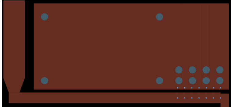
Figura 62.- Plano de tierra y vías (en azul claro) donde irán conectados los capacitores de desacoplamiento
