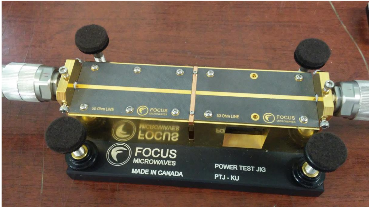
Figura 98.- Test fixture para el transistor
