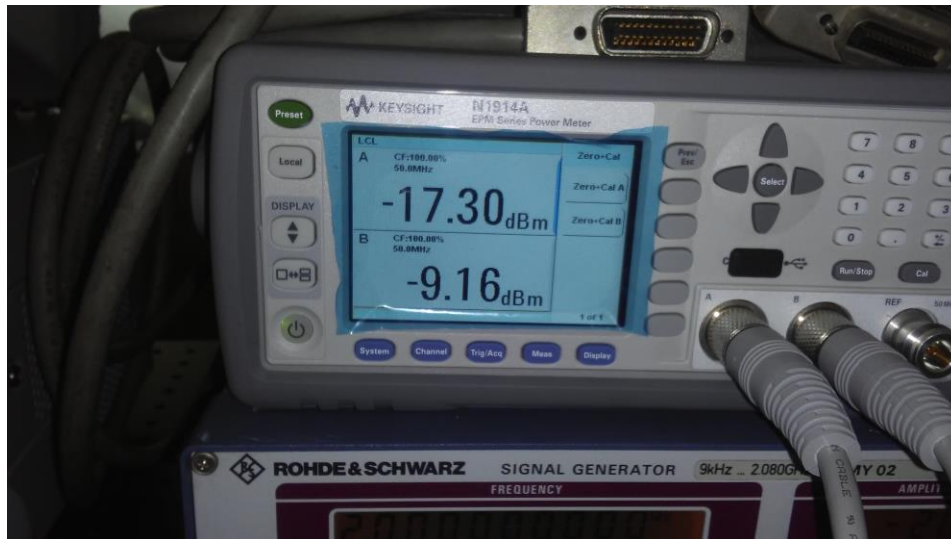
Figura 114.- Potencia de entrada (arriba) y salida (abajo) con el nuevo punto de polarización
