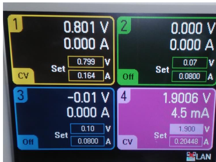
Figura 113.- Voltaje y Corriente de Drenaje (Canal 4)
