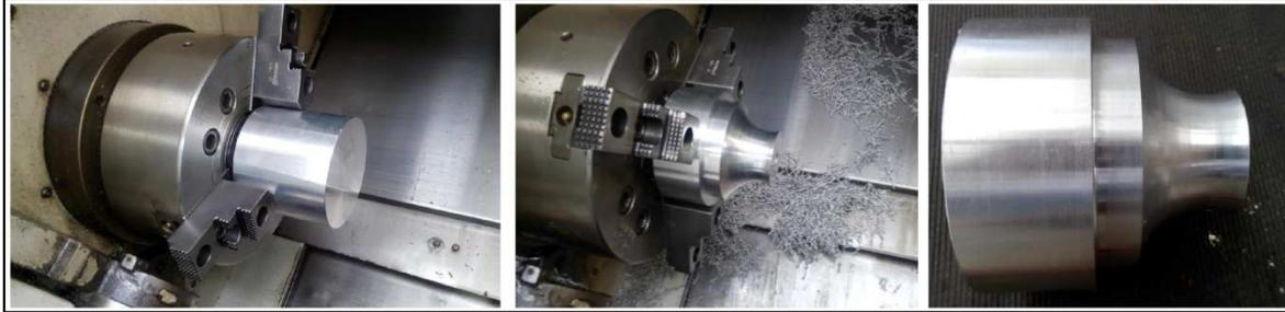
**Paso 5.** Implementación del modelo para maquinado en CNC. El modelo generado en un sistema de CAD, es implementado en un programa para realizar la simulación y código para el maquinado. Esta secuencia se aprecia en la **Figura 54**.
