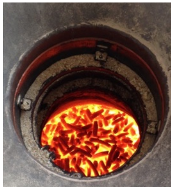
Fotografía 11: Vista interior de proceso de piro-gasificación de olote de maíz. Fuente: G2E.
