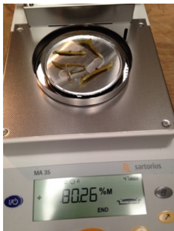
Fotografía 5: Medición de contenido de humedad mediante balanza termogravimétrica. Fuente: G2E.
