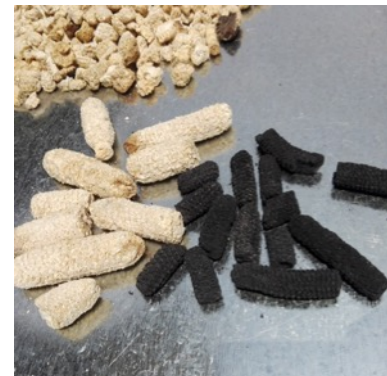
Fotografía 12: Olote de maíz y biocarbón de olote de maíz después de piro gasificación. Fuente: G2E.
