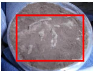
Figura 6.32 Con una muestra de  $\text{NaAsO}_2$  a 300 mg/kg y 500 mg/kg de  $\text{Pb}(\text{NO}_3)_2$  con todos los organismos muertos y degradados.
