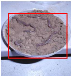
Figura 6.26 Con una muestra de  $Pb(NO_3)_2$  a 4000mg/kg con todos los organismos muertos y con pérdida en su coloración.18
