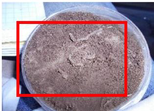
Figura 6.33 Con una muestra de  $\text{NaAsO}_2$  a 200mg/kg y 500 mg/kg de  $\text{Pb}(\text{NO}_3)_2$  con todos los organismos muertos y degradados.
