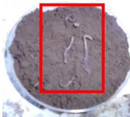
Figura 6.20 Con una muestra de  $\text{NaAsO}_2$  a 500 mg/kg. Se presentaron todos los organismos enroscados y muertos. 13
