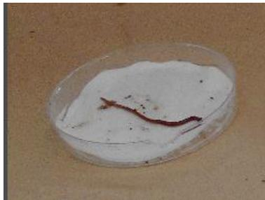
Figura 6. 5 Muestra de 4 ml de agua destilada y una lombriz de tierra húmeda viva sin evadir el medio filtro.
