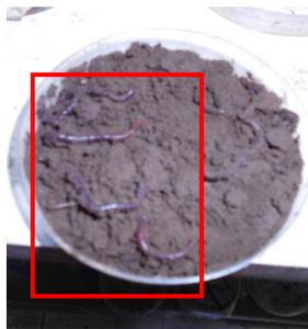
Figura 6.27 Con una muestra de  $Pb(NO_3)_2$  a 3000mg/kg con 4 organismos muertos indicados en un rectángulo rojo.
