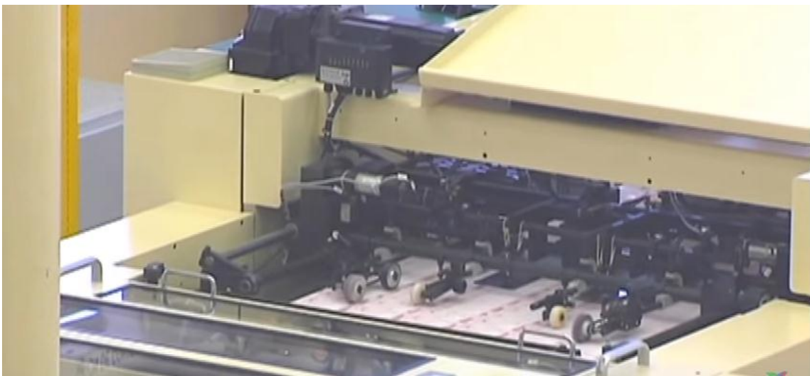
Ilustración 20. Desalineación de las hojas al ser transferidas hacia la entrada de la máquina.
