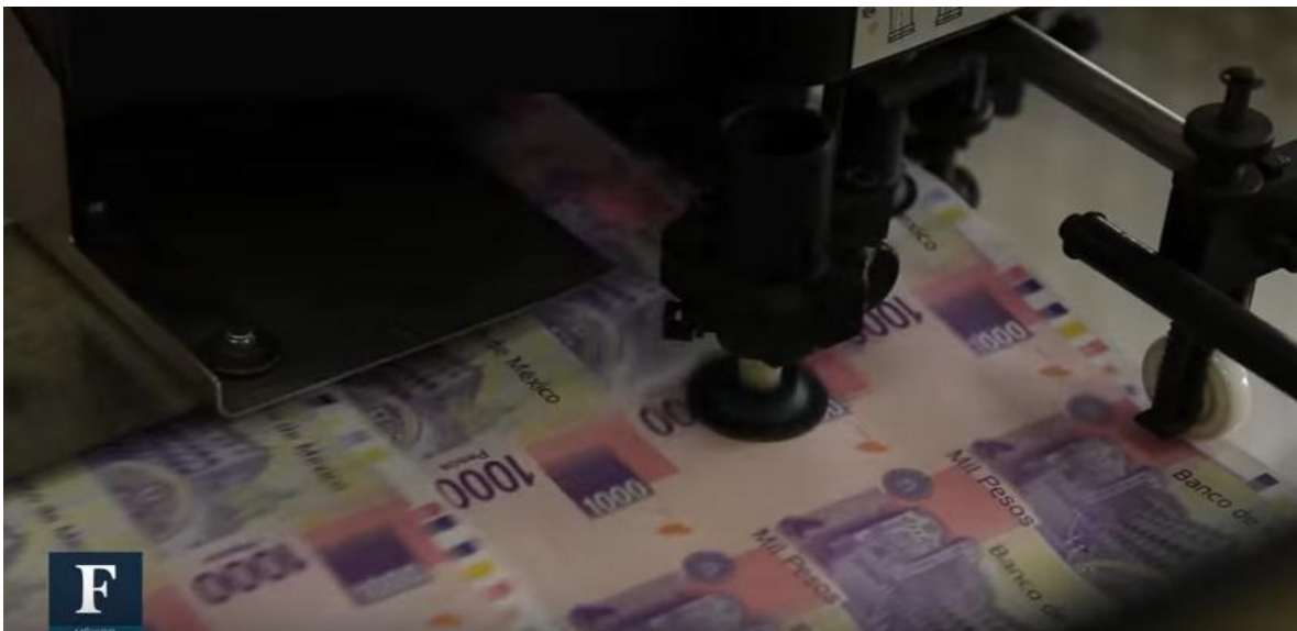
Ilustración 19. Los billetes son transportados a la entrada de la maquina mediante un mecanismo llamado (feeder)
