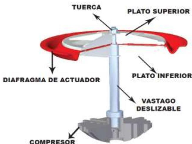
Figura 8. Ensamble de platos con diafragma de actuador.
