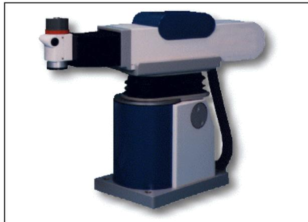
**Híbridos:** Estos robots corresponden a aquellos de difícil clasificación cuya estructura resulta de una combinación de las expuestas anteriormente.
