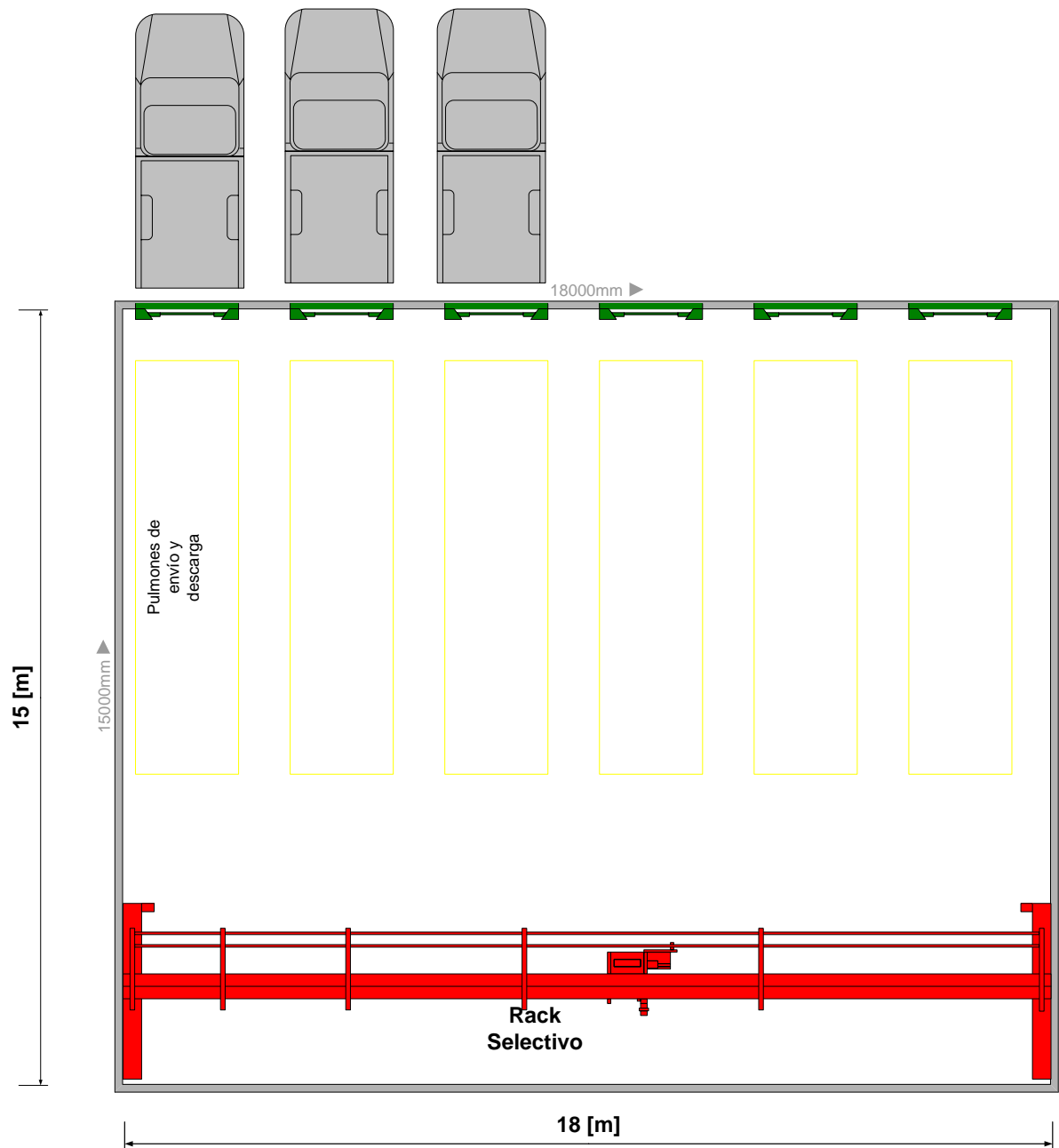
Figura 12 Lay Out proceso rediseñado
