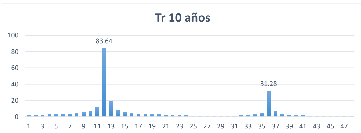
Figura 120 Hietograma de diseño, Tr 10 años, "Cuatotolapan"
