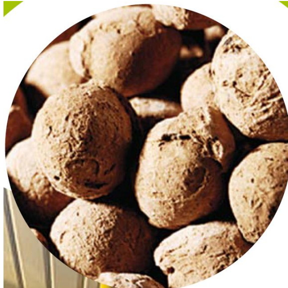
Figura 2.9. Medio de soporte Biofor® de Suez-Dégremont.
