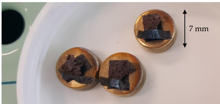
Figura 6.4. Colocación de muestras en soportes metálicos.
