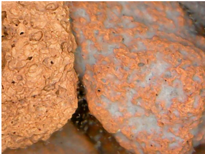
Figura 6.9. Medio de soporte (tezontle) sin y con biopelícula.
